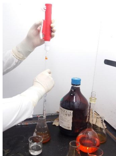
I. Preparación de muestras para titulación, ( \text{K}_2\text{Cr}_2\text{O}_7 )
