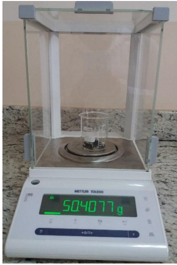
A. Medición de muestras húmedas
