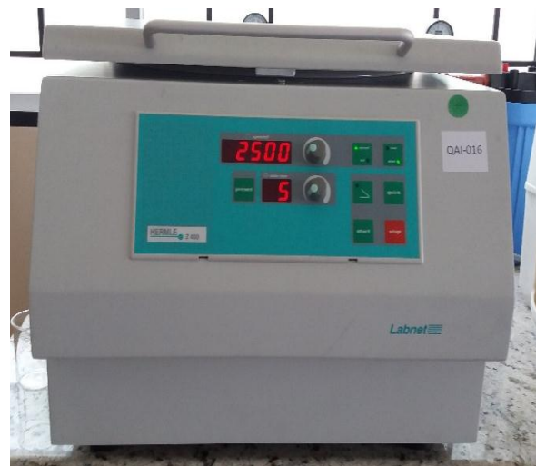
D. Centrifugación de muestras a 2500 rpm
