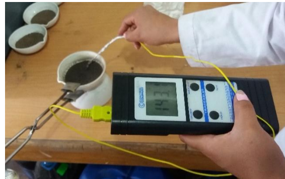
D. Medición de temperatura del suelo después de la quema
