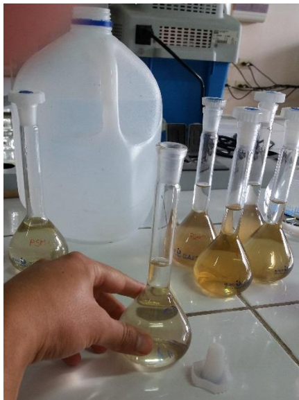
F. Preparación de soluciones para CIC
