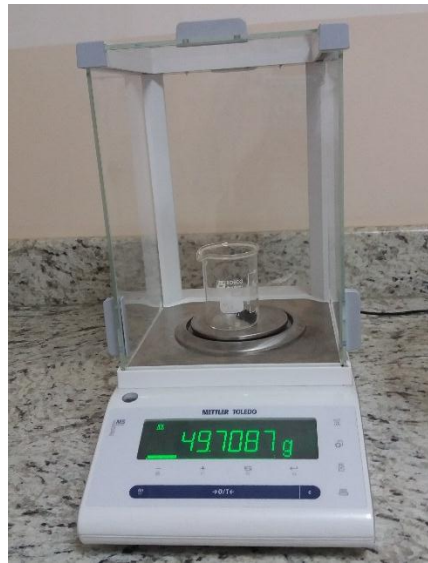
C. Medición de muestras secas
