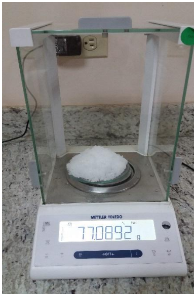
A. Pesaje del reactivo Acetato de Amonio ( C_2H_7NO_2 )
