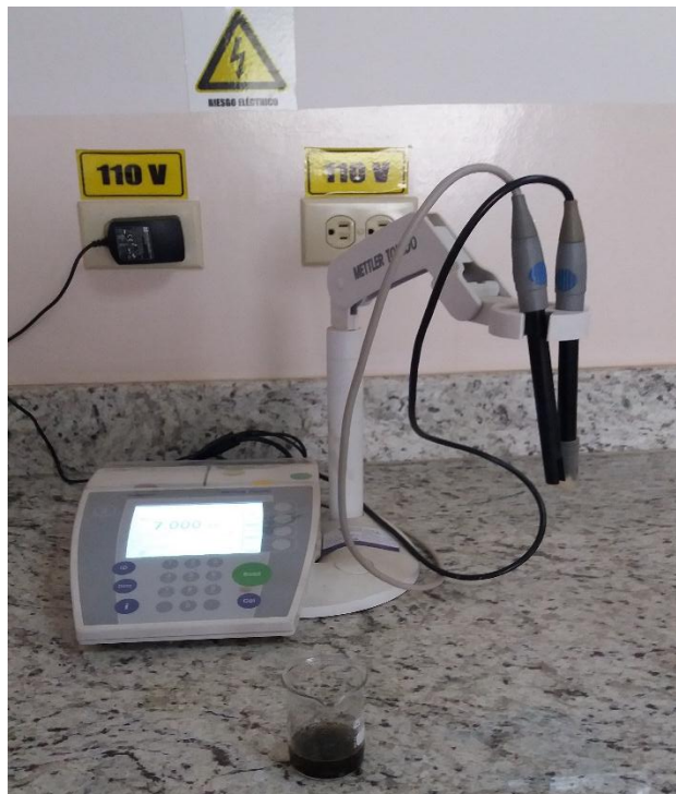
D. Medición del potencial Hidrogeno
