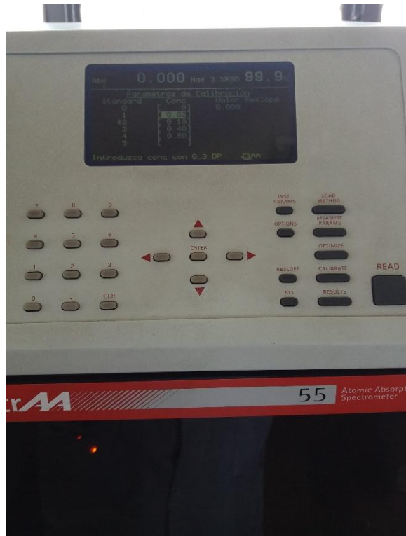
H. Espectrofotómetro de absorción atómica de llama
