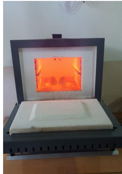
B. Pre calentamiento del horno eléctrico a 1000°C
