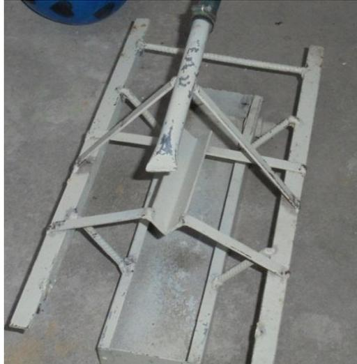
En la Figura 2.17, se observa un estructura de hierro diseñada específicamente para el enfriado el material extruido en la cual posee recipiente en el cual esta justado un canal con ranuras para que pueda salir líquido refrigerante, generalmente agua para poder enfriar el objeto que salga por el extrusor. En la parte superior de esta estructura se puede observar que hay una conexión para colocar una manguera accediendo al suministro del líquido refrigerante.
