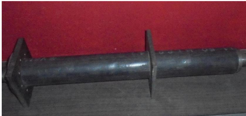
El cilindro que permitirá realizar el proceso de extrusión se puede visualizar en la Figura 2.15 tiene dos soportes y también consta de abrazaderas para poder transmitir la energía calorífica para que se pueda fundir el material ingresado.
