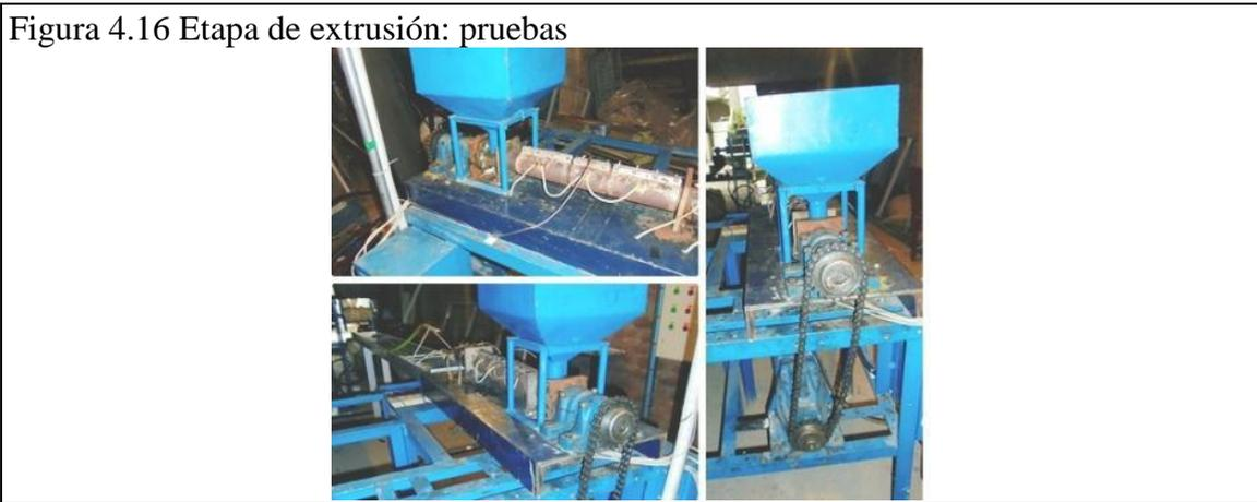
En la etapa de extrusión se realizó las pruebas de funcionamiento del motor que hace girar al husillo por medio de una transmisión, la corriente nominal es de 3.94 A y la corriente medida es de 2.60 A. Para proteger al motor se incorpora un relé térmico regulable (rango de 2.5 a 4 A), se calibra al relé en 4 A.
