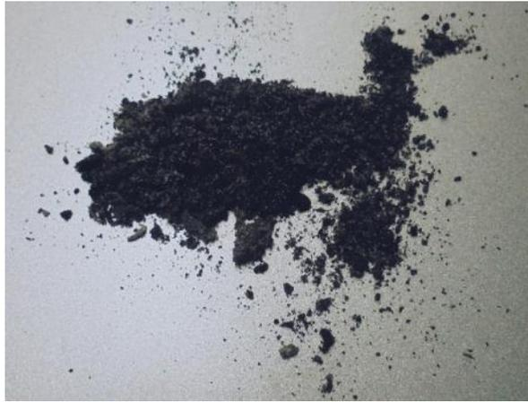
En la Figura 2, se observa el material extruido sometido a una temperatura de entre  $160^{\circ}\text{C}$  a  $180^{\circ}$ , en donde se carbonizó el PVC emanando una nube de gases tóxicos hacia el medio ambiente siendo inservible este producto resultante. Las pruebas se realizaron con el PVC granulado y en con el PVC en polvo obteniendo similares resultados.
