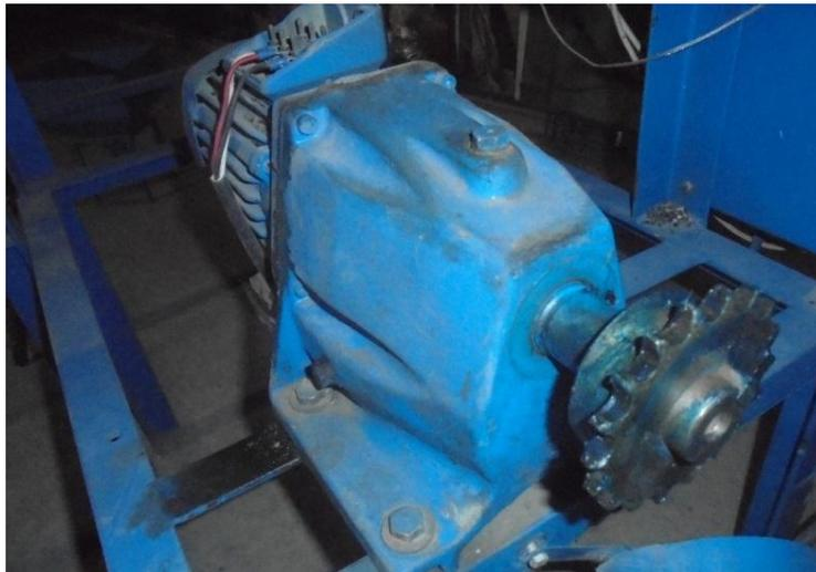
En la imagen de la Figura 2.19, se observa el motor que permitirá dar el giro al husillo transmitiendo la energía por una cadena y realizar el torque necesario para la extrusión.
