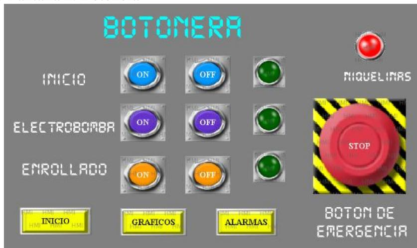
La Figura 4.13 muestra segunda pantalla que visualizara los pulsadores que controlan la máquina, tienen mandos de encendido y desactivado con sus respectivos indicadores. El botón de emergencia detendrá todos los procesos del extrusor por lo cual tiene mayor tamaño. Se encuentra un indicador para las niquelinas, su encendido depende de la temperatura proporcionada en el tambor.
