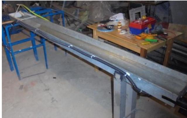
En la figura 4.5, se visualiza la etapa de enfriado la cual está compuesto de una canaleta donde se almacena el líquido que refrigerara el vinil extruido, una electrobomba que cumplirá la función de recircular el agua, este dispositivo se encuentra conectado a una estructura ranurada por donde goteara el fluido para enfriar el material restante. Es necesario que la estructura tenga una ligera inclinación para mantener al motor cebado y evitar daños en este elemento.
