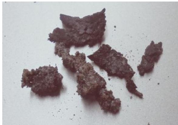
En la Figura .22, se observa la materia prima extruida en un rango de  $130^{\circ}\text{C}$  y  $140^{\circ}\text{C}$  de temperatura, se visualiza una materia prima más compacta y con una mejor textura, estas pruebas se las realizo sin matriz ni homogeneizador por problemas mecánicos, lo cual no tiene la forma final de la matriz pero se logra hallar la temperatura adecuada para la extrusión.
