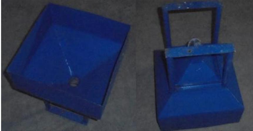
En la Figura 2.18, se visualiza la tolva en forma parecida a un embudo. Tiene una capacidad de  $0.025\text{m}^3$  esta tolva tiene la función de permitir el paso del PVC hacia el cilindro para que sea tratado por el husillo, siendo este la partida de este proceso.
