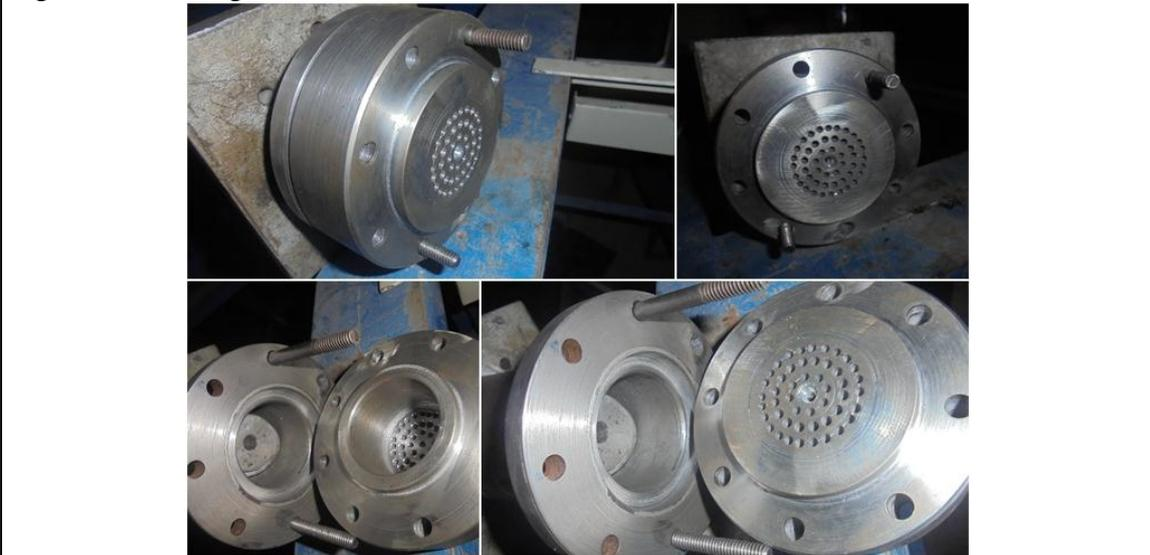
En la Figura 4.2, se puede observar un elemento implementado en la máquina extrusora que se lo conoce como homogeneizador, es un filtro que recibe todo el material extruido y lo tamiza para posteriormente pasarlo por la boquilla de la matriz, esta pieza se encuentra entre el tambor que contiene el husillo y la matriz para moldear el vinil.
