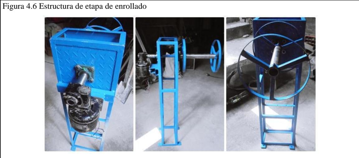
En la Figura 4.6, se visualiza la estructura de la etapa de enrollado la cual comprende de un carrete desmontable para poder retirar el vinil y se encuentra acoplado un motoreductor que ayudara a envolver el material extruido para terminar el proceso de extrusión
