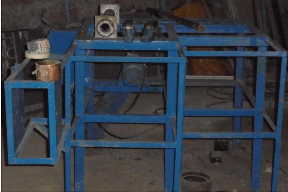
En la Figura 2.14, se puede observar la totalidad de la estructura de la máquina extrusora la cual consta de un calentador por donde pasa el PVC, un motor Trifásico, el sistema de transmisión tipo cadena, un husillo, una matriz o boquilla, sistema de enfriado y un panel de control.
