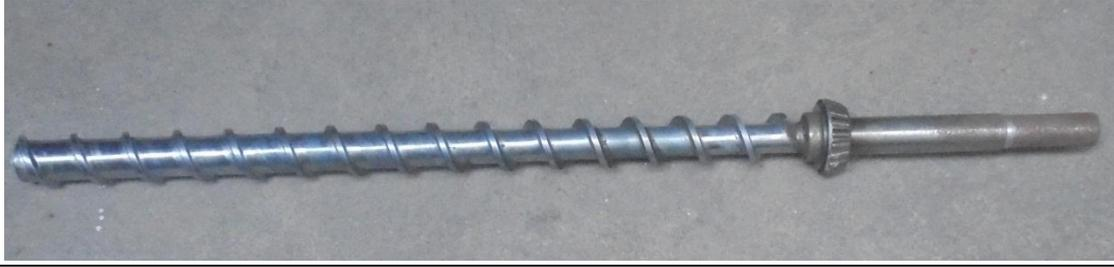
En la Figura 2.16, se puede observar el husillo perteneciente a la máquina extrusora que sirve para mezclar el material en el tambor, haciendo que pase por las tres etapas de extrusión. El husillo de la figura ingresa un rodamiento que le ayudará a hacer el movimiento rotacional necesario para el proceso.
