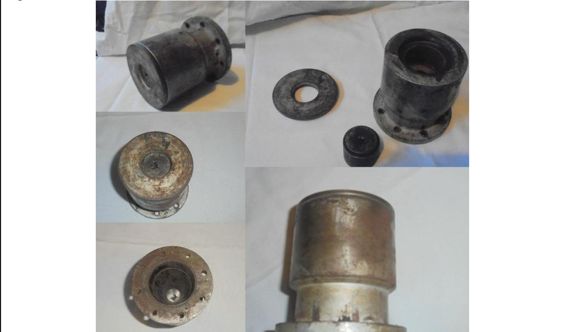
En la Figura 2.21, se puede observar la parte final del extrusor, la matriz, que comprende de tres partes: El cuerpo de la matriz, la boquilla de moldeo y la tapa de la matriz. Al retirar este último se puede cambiar fácilmente la boquilla y tener diferente
