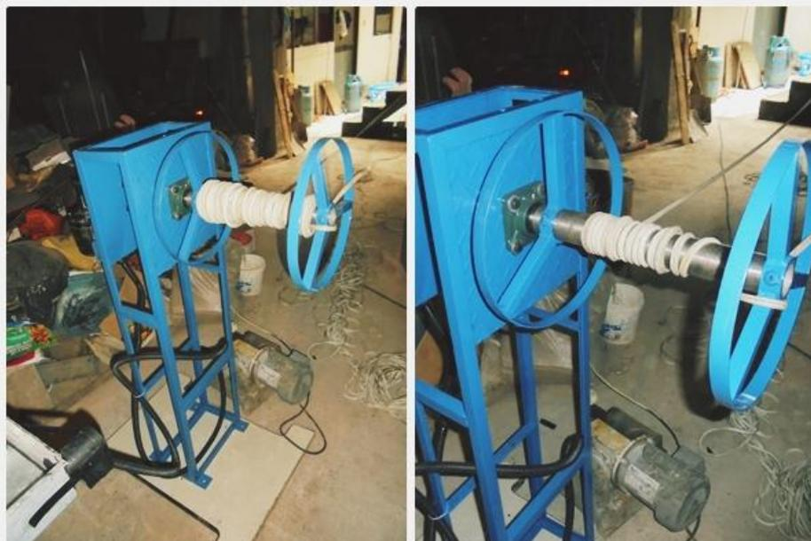
En la etapa de enrollado se tiene un moto reductor que trabaja a 110 V y tiene una corriente nominal de 3 A, tiene una reducción de 1425 a 95 revoluciones por minuto, y la corriente medida en este motor es de 2.50 A. Se enrolla el vinil una vez terminado de extruir guiando el producto para evitar que se enrede en este proceso, sujetando un
