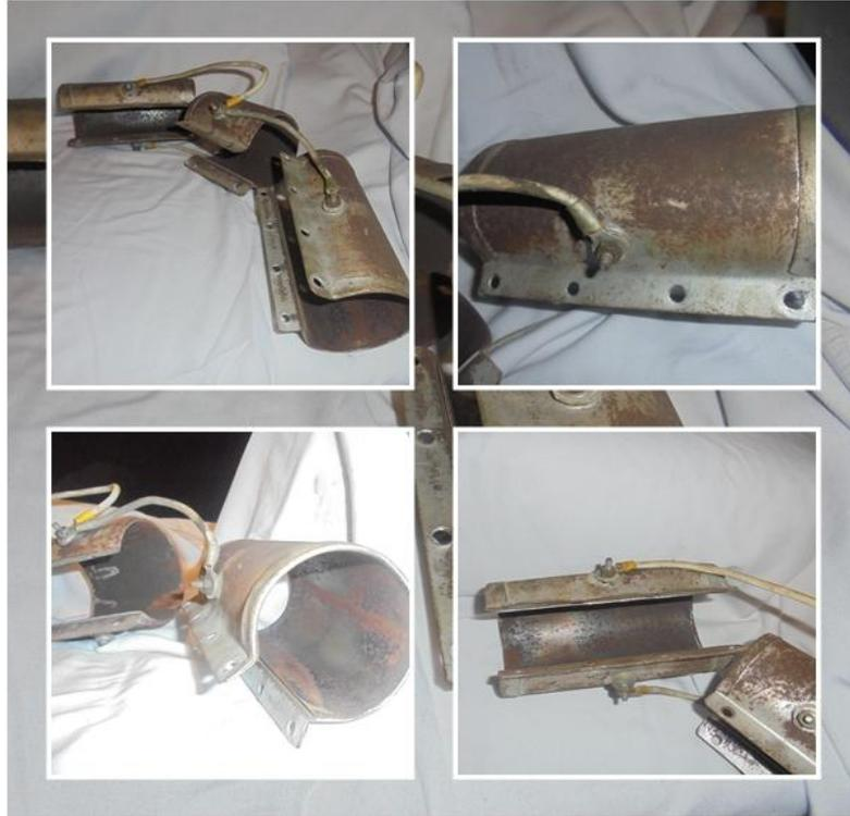
En la Figuran 2.22, se puede visualizar las niquelinas empleadas en el extrusor. Estos objetos estan diseñados con una potencia de 900 watts. Las niquelinas estan compuestas por dos láminas de acero común y entre estas láminas tiene alambre de tugsteno para trasformar la energía eléctrica en energia termica, calentando asi el tambor del extrusor. Los puntos estan conectados en serie mediante cable térmico siliconado que soportara el calor generado en esta trasferencia de energía.
