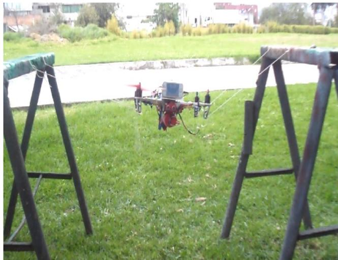
Prueba del sensor giroscopio eje Y
