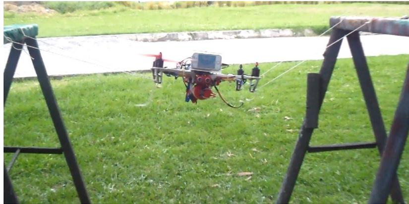
Prueba del sensor giroscopio eje X
