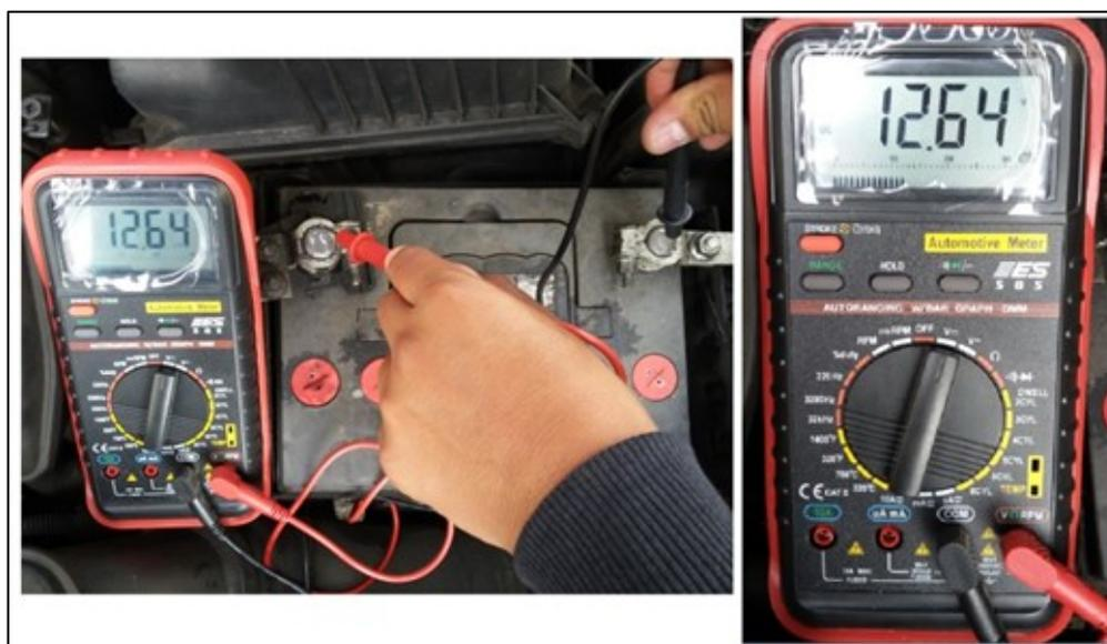
En la Figura 4.2 se muestra el valor real de corriente de entrada de la batería que alimenta al convertidor flyback. Para obtener el valor de corriente real se utilizó un multímetro automotriz de la marca ES modelo 585K en la escala de medida amperios.
