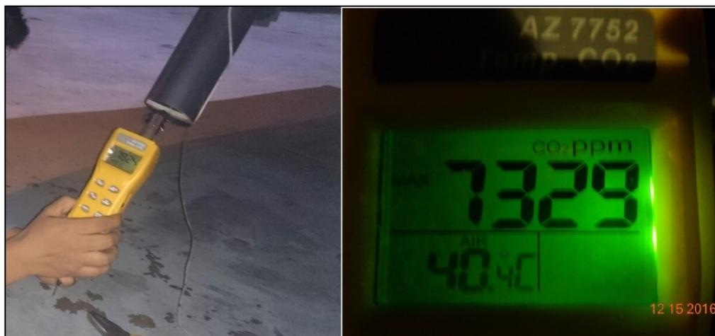
Se obtuvo 30 datos del filtro electrostático encendido para hacer una comparación con los primeros datos del filtro electrostático apagado. En la Figura 4.5 se muestra el valor en ppm que entrega el filtro electrostático encendido.
