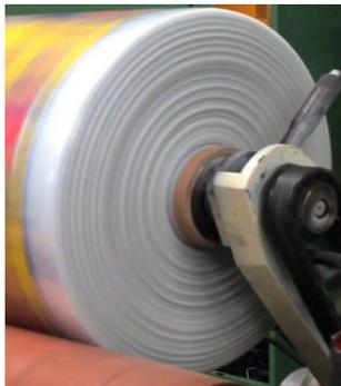
Prueba realizada en la máquina KAMPF con polietileno de baja densidad con impresión y laminado sin refilo, se observa un rollo rebobinado correctamente, Carlos Hernández y Juan Oquendo.
