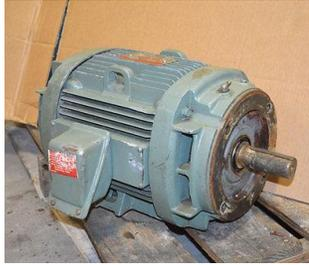
Motor trifásico AC General Electric utilizado para generar el movimiento del cilindro que controla los engranajes de rebobinado. (TEREAPEK, 2016).
