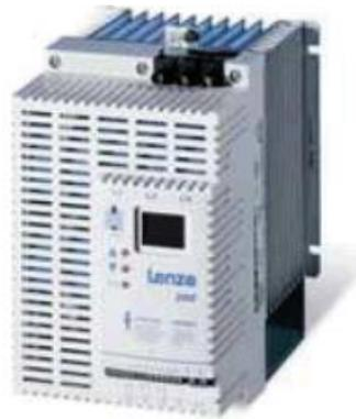
Variador de velocidad Lenze utilizado para realizar el control de velocidad de motores trifásicos, se implementó dos variadores en la automatización, (Transdrive, s.f.).
