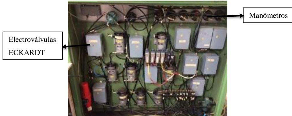
Parte posterior del tablero de mando de la máquina KAMPF, se observa las electroválvulas y válvulas reguladoras de flujo de aire, Carlos Hernández y Juan Oquendo.
