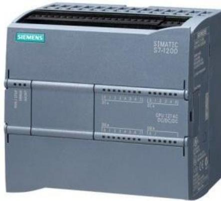
PLC Siemens S7-1200 implementado en la automatización de la rebobinadora KAMPF, con CPU 1214c y relés incorporados en sus salidas, (Siemens AG, 2009).
