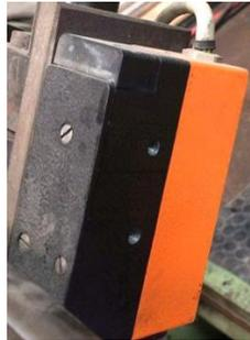
Sensor foto-eléctrico implementado en el módulo de alineación, su salida de voltaje varía entre 0 y 5V, Carlos Hernández y Juan Oquendo.
