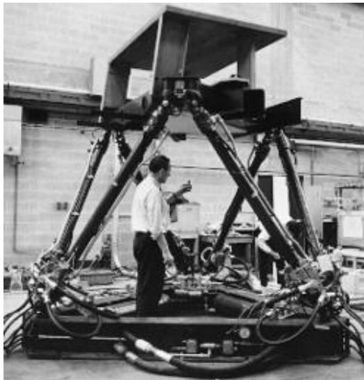
Simulador de vuelo basado en el diseño de Cappel, (Villate, 2015).
