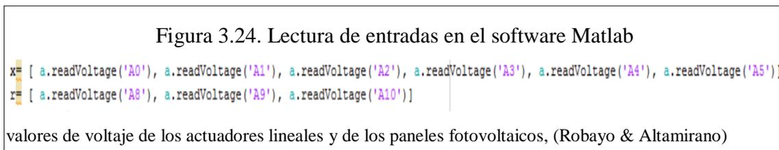
La matriz denominada “f” se usó para la activación de los actuadores lineales conocidos como salidas dentro de la programación de la tarjeta Arduino. A través del comando
