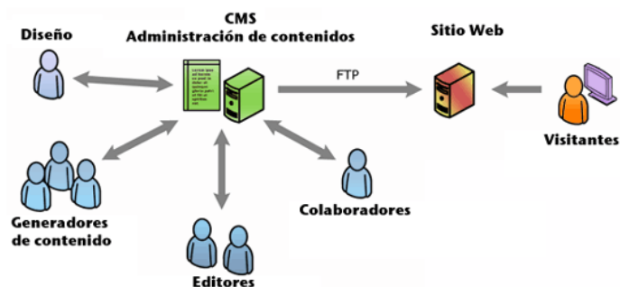
Figura 3.22 Esquema básico del funcionamiento de un CMS.
