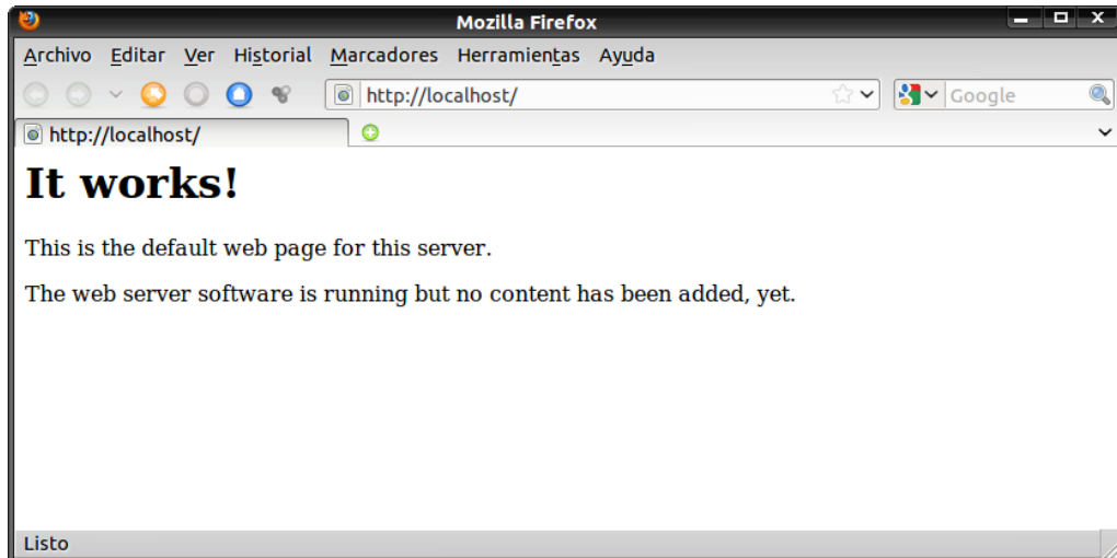
Figura 3.46 Prueba de funcionamiento de Apache2 .
