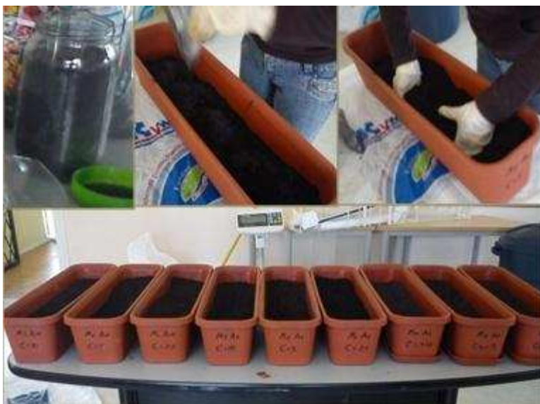
Figura 6. Preparación de suelos contaminados con plomo.
