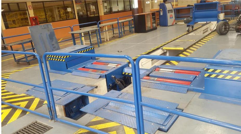
**Figura 4. 8.** Banco dinamométrico.
