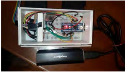
**Fig. 4.** Circuito detector de pulsos
