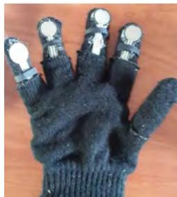
**Fig. 3.** Guante con sensores acoplados
