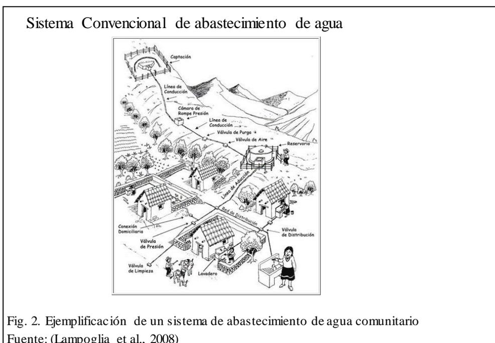
Fig. 2. Ejemplificación de un sistema de abastecimiento de agua comunitario
