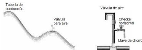
Fig. 5. Estructura de una válvula de aire
