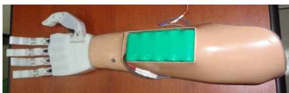
Figura 3.88: Ubicación del acumulador en el socket.
