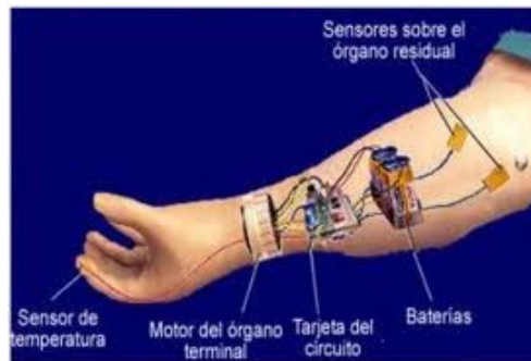
Figura 2.21: Partes de la prótesis mioeléctricas. Fuente [4].
