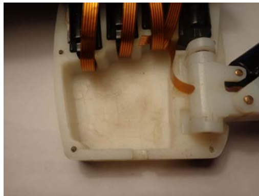
Figura 3.89: Cavidad para circuitos de control.
