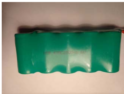
Figura 3.86: Acumulador NiMH 2800 mAh.
