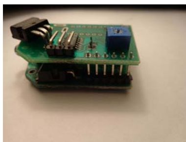
Figura 3.110: Montaje de circuito impreso final.
