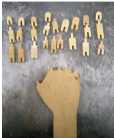
Figura 3.4: Modelo de los cinco dedos y palma en MDF.
