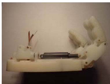
Figura 3.63: Posiciones intermedias de los dedos.
