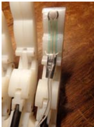
Figura 3.120: Galga extensiométrica sobre la superficie frontal de los dedos.
