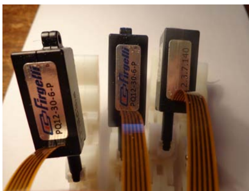
Figura 3.74: Ubicación de actuadores PQ12-30-06-P.
