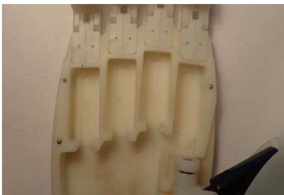
Figura 3.73: Cavidades en la palma para actuadores PQ12.
