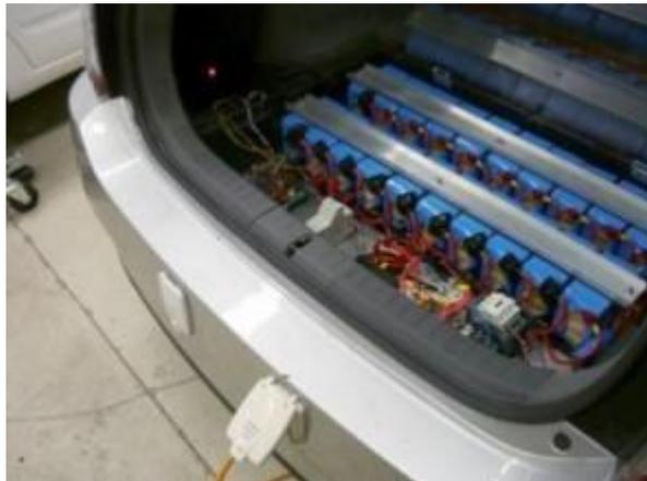
*Figura 4. Baterías de los Vehículos eléctrico.
