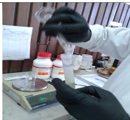
j. Se colocó en el sobrenadante a un tubo de centrífuga de 15 mL que contenía 1,5 g de  $MgSO_4 \cdot H_2O$  y 0,250 g de PSA,
