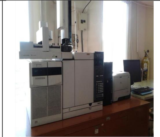
n. Cromatógrafo de gases acoplado a masas de marca Agilent Technologies 7890B GC System
