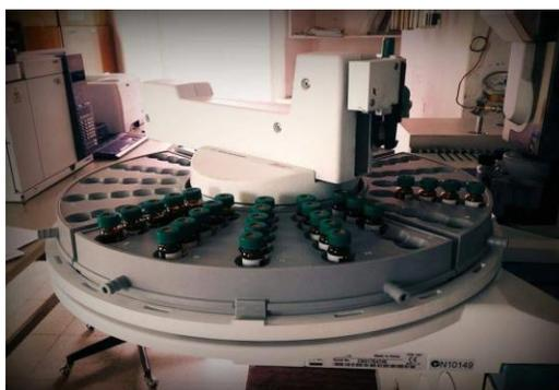
e. Colocación de las muestras en el GC/MS después de ser diluidas 3 veces de 50  $\mu$ L a 1 mL.
