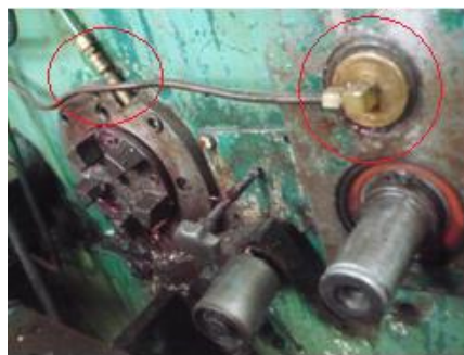
Gráfico 3.149: Conexión del sistema de lubricación lado máquina (P.sup – P.inf).
