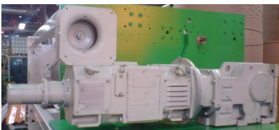
Gráfico 4.11: Motor reductor que acciona rodillo engomador y dosificador
