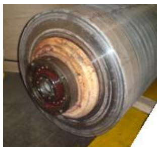
Gráfico 3.114: Desmontaje del rodillo engomador Fuente: Los Autores
