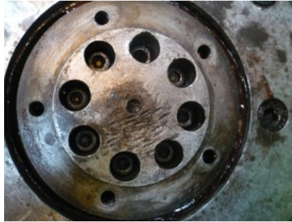
Gráfico 3.99: Limpieza de la brida intermedia Fuente: Los Autores
