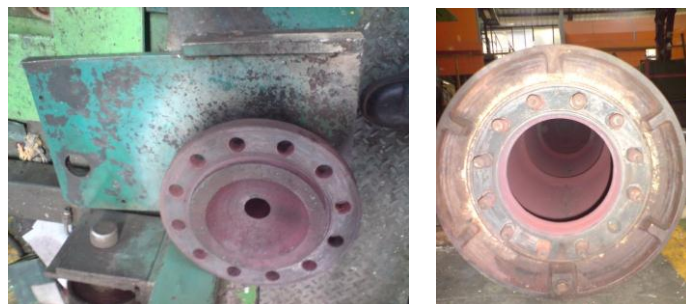
Gráfico 3.163: Desmontaje de la placa de soporte inferior. Fuente: Los Autores
