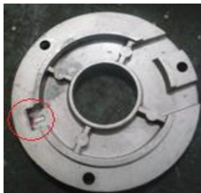
Gráfico 3.50: Tapa del rodamiento (ingreso de grasa) Fuente: Los Autores
