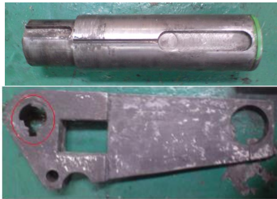
Gráfico 3.125: Palanca reguladora desacoplado el eje Fuente: Los Autores
