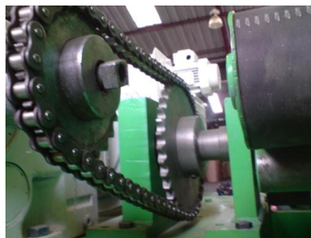
Gráfico 3.187: Montaje de la cadena. Fuente: Los Autores
