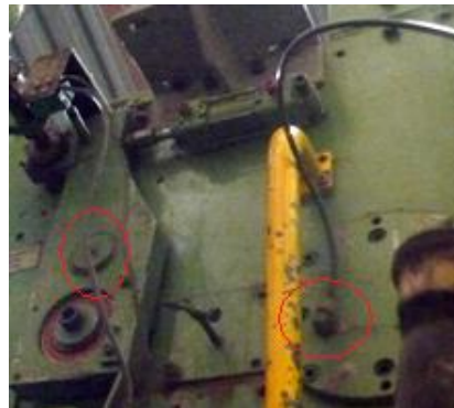
Gráfico 3.150: Conexión del sistema de lubricación lado operario (P.sup – P.inf).
