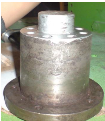
Gráfico 3.101: Mantenimiento de la brida intermedia
