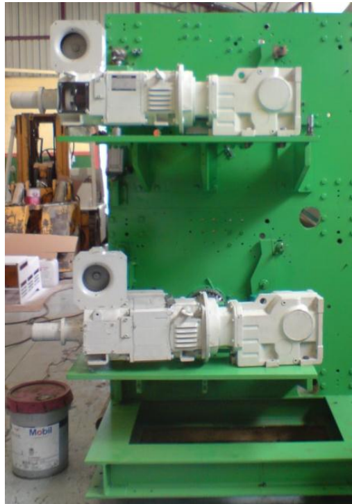
Gráfico 3.184: Montaje del motor reductor LM Fuente: Los Autores
