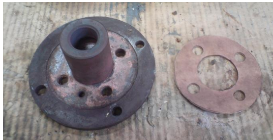
Gráfico 3.159: Desmontaje de la brida intermedia. Fuente: Los Autores
