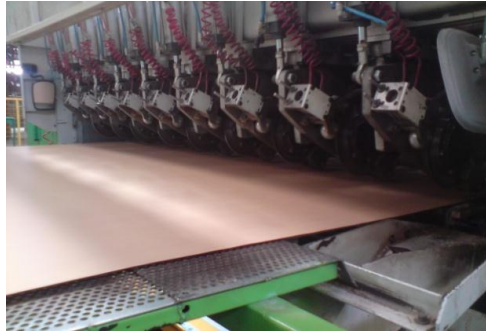
Gráfico 1.21: Cuchillas que conforman la Slitters score Fuente: Los Autores
