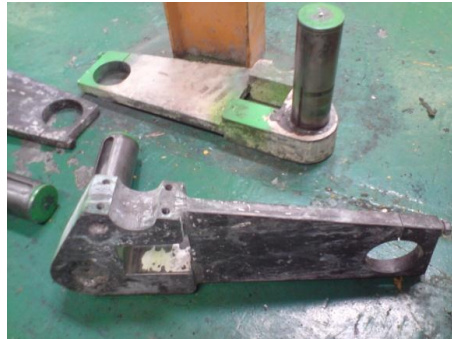
Gráfico 3.122: Desmontaje de la palanca reguladora LO LM. Fuente: Los Autores
