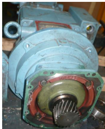
Gráfico 3.39: Sistema que transmite el movimiento del motor al reductor Fuente: Los Autores
