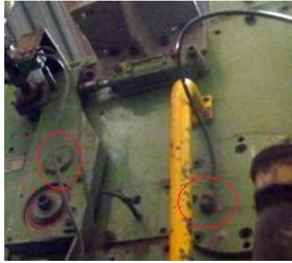
Gráfico 3.150: Conexión del sistema de lubricación lado operario (P.sup – P.inf). Fuente: Los Autores
