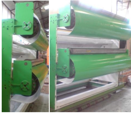
Gráfico 3.197: Montaje de las guardas del rodillo precalentador. Fuente: Los Autores
