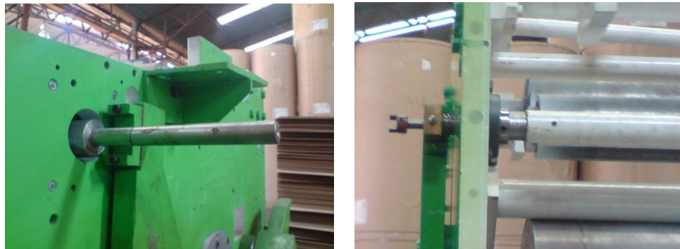
Gráfico 3.189: Montaje de los ejes que transmiten el movimiento de lado operario al lado máquina Fuente: Los Autores
