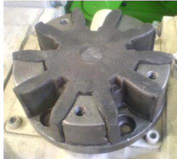
Gráfico 3.6: Empaque del acople metálico (no existe repuesto)
