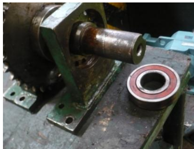
Gráfico 3.10: Desmontaje del rodamiento 6309 LU Fuente: Los Autores
