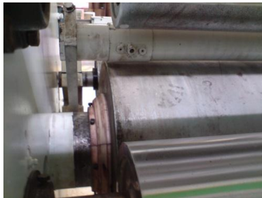
Gráfico 3.196: Montaje del anillo protector. Fuente: Los Autores
