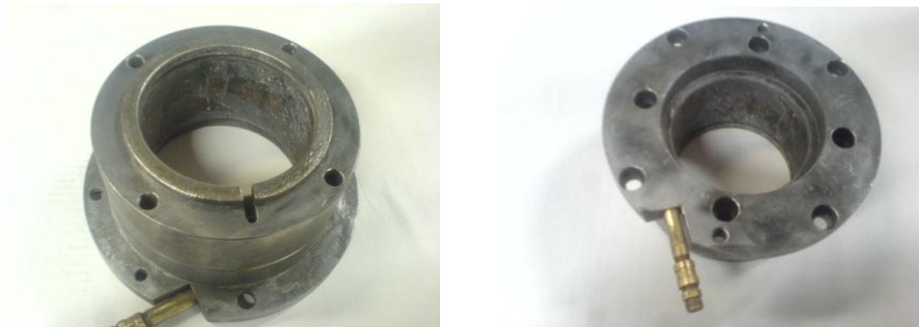
Gráfico 3.111: Mantenimiento de las bridas de cojinete lado máquina Fuente: Los Autores
