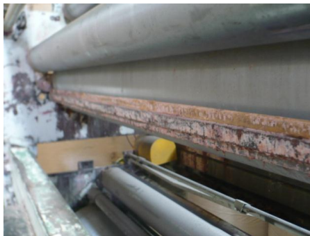
Gráfico 3.83: Bandeja del adhesivo desacoplada de la máquina Fuente: Los Autores
