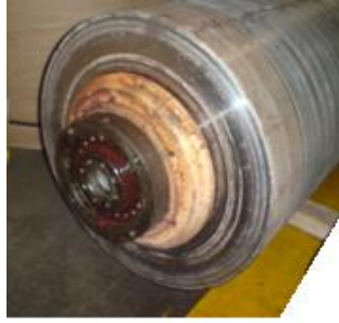
Gráfico 3.114: Desmontaje del rodillo engomador Fuente: Los Autores
