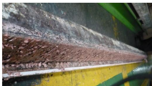
Gráfico 3.94: Desacoplamiento del raspador del rodillo dosificador (P.sup – P.inf). Fuente: Los Autores
