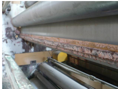
Gráfico 3.83: Bandeja del adhesivo desacoplada de la máquina Fuente: Los Autores
