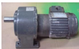
Gráfico 4.12: Motor reductor que regula y calibra el rodillo dosificador
