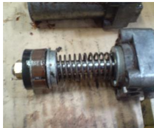
Gráfico 3.72: Comprobación de estado del resorte Fuente: Los Autores
