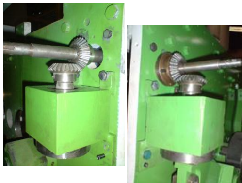
Gráfico 3.191: Montaje de los bloques del sistema de regulación rodillo pisador Fuente: Los Autores
