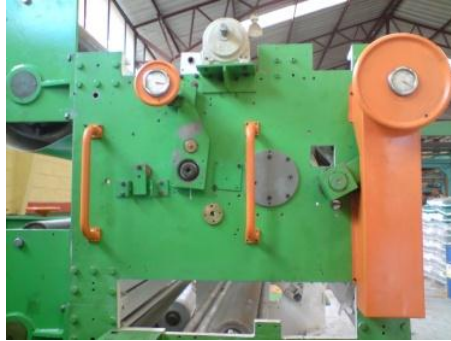
Gráfico 3.199: Montaje de las tapas protectoras Fuente: Los Autores
