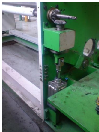
Gráfico2.6: Accionamiento manual del rodillo pisador
