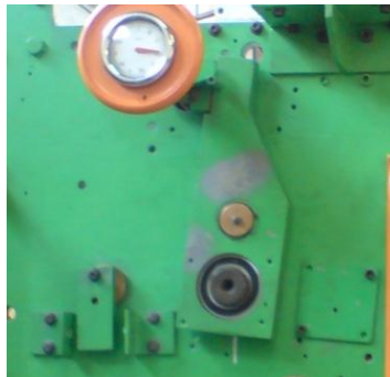
Gráfico2.3: Accionamiento manual del rodillo dosificador Fuente: Los Autores
