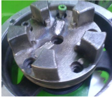
Gráfico 3.7: Acople metálico (no existe repuesto) Fuente: Los Autores
