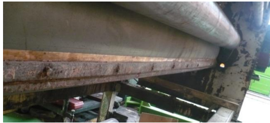
Gráfico 3.90: Desmontaje de los raspadores Fuente: Los Autores
