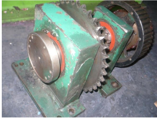
Gráfico 3.2: Desmontaje del sistema de transmisión Fuente: Los Autores
