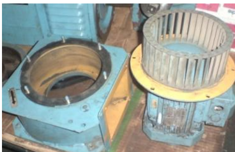
Gráfico 3.24: Desmontaje del ventilador del motor AAB
