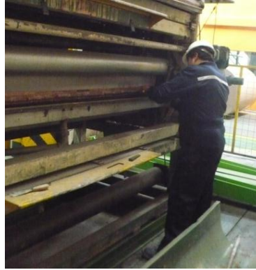
Gráfico 3.77: Desmontaje del soporte fijador Fuente: Los Autores
