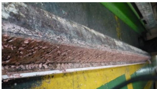
Gráfico 3.95: Desmontaje del sujetador del raspador Fuente: Los Autores
