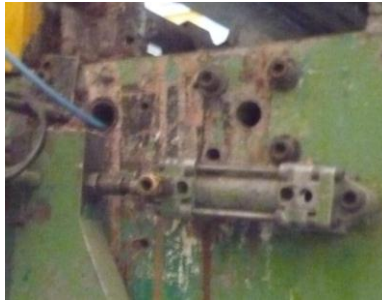
Gráfico 3.68: Desmontaje del actuador Fuente: Los Autores
