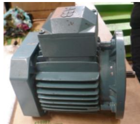
Gráfico 3.35: Motor ABB del ventilador Fuente: Los Autores
