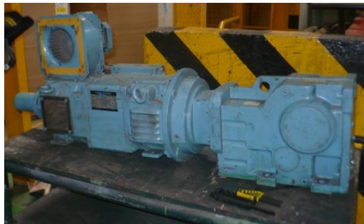
Gráfico 3.23: Desmontaje del motor reductor Fuente: Los Autores
