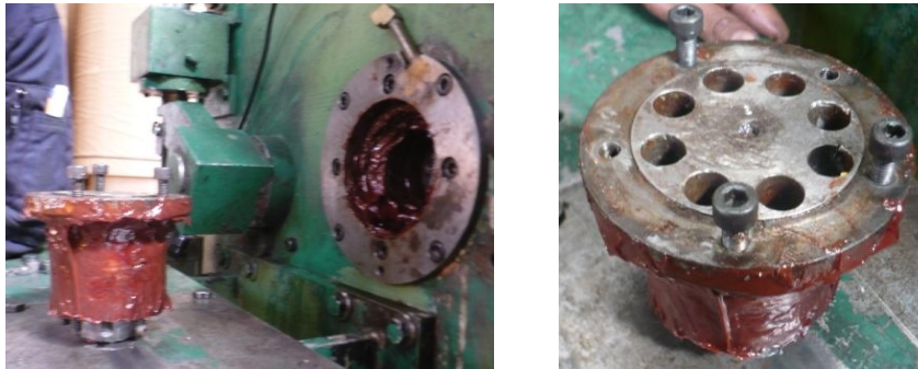
Gráfico 3.100: Desmontaje de la brida intermedia Fuente: Los Autores
