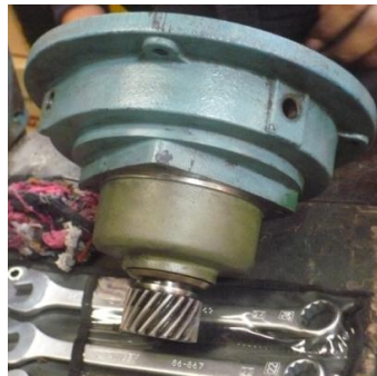
Gráfico 3.41: Mantenimiento del sistema que permite el movimiento del motor al reductor Fuente: Los Autores
