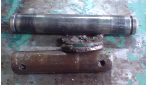
Gráfico 3.66: Desmontaje de los pasadores respectivos Fuente: Los Autores
