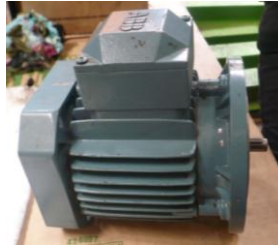
Gráfico 3.35: Motor ABB del ventilador Fuente: Los Autores
