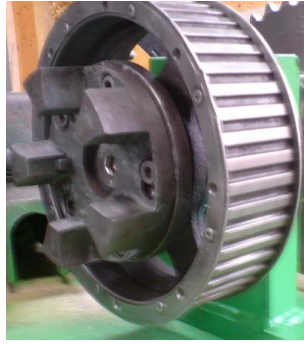
Gráfico 3.9: Rueda dentada corregida y reparada Fuente: Los Autores
