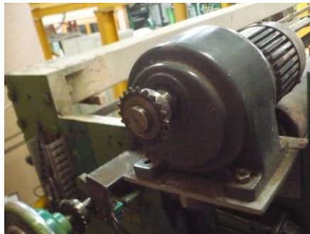
Gráfico 3.55: Desmontaje del motor reductor Fuente: Los Autores
