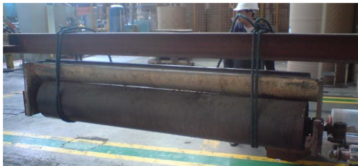
Gráfico 3.156: Desmontaje del pre-acondicionador Fuente: Los Autores
