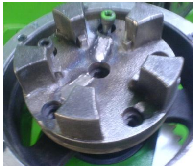
Gráfico 3.7: Acople metálico (no existe repuesto)
