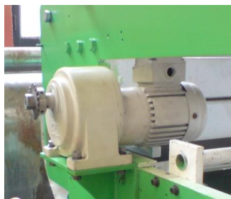
Gráfico 3.185: Montaje del motor reductor LO Fuente: Los Autores
