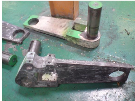
Gráfico 3.122: Desmontaje de la palanca regulador LO LM. Fuente: Los Autores
