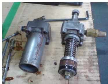
Gráfico 3.71: Actuador de simple efecto desacoplado sus mecanismos Fuente: Los Autores
