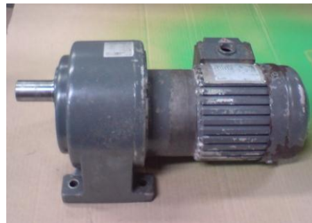
Gráfico 3.21: Motor reductor que regula y calibra el rodillo dosificador (lado operario) Fuente: Los Autores
