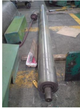
Gráfico 3.160: desmontaje del rodillo guía (P.sup – P.inf). Fuente: Los Autores
