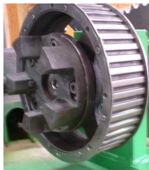
Gráfico 3.9: Rueda dentada corregida y reparada Fuente: Los Autores
