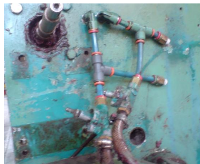
Gráfico 3.74: Desmontaje de las mangueras Fuente: Los Autores
