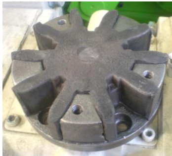
Gráfico 3.6: Empaque del acople metálico (no existe repuesto) Fuente: Los Autores
