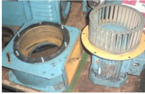
Gráfico 3.24: Desmontaje del ventilador del motor AAB Fuente: Los Autores
