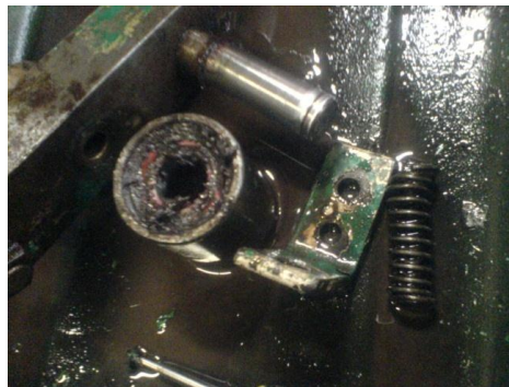
Gráfico 3.17: Desmontaje del sistema de compresión. Fuente: Los Autores
