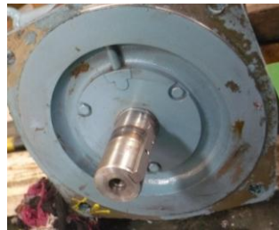
Gráfico 3.48: Desmontaje del rotor. Fuente: Los Autores
