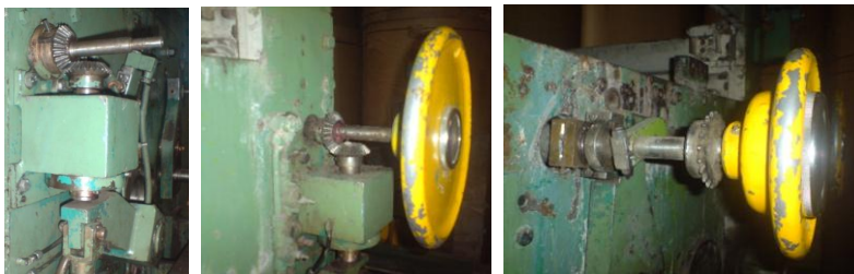
Gráfico 4.7: Sistema de ajuste del rodillo pisador y dosificador
