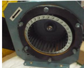
Gráfico 3.25: Mantenimiento del ventilador del motor ABB Fuente: Los Autores
