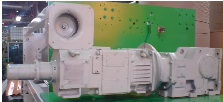
Gráfico 3.20: Motor reductor que acciona rodillo engomador y dosificador (lado máquina) Fuente: Los Autores
