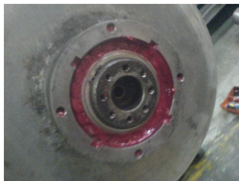
Gráfico 3.173: Montaje del anillo al rodillo Fuente: Los Autores
