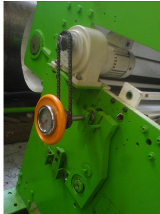
Gráfico 3.190: Montaje del sistema de regulación rodillo dosificador Fuente: Los Autores
