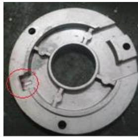
Gráfico 3.50: Tapa del rodamiento (ingreso de grasa) Fuente: Los Autores
