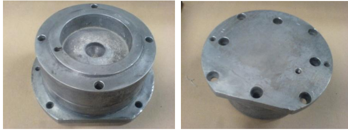
Gráfico 3.109: Mantenimiento de las bridas de cojinete lado operario Fuente: Los Autores
