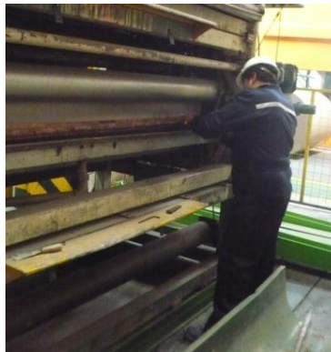
Gráfico 3.77: Desmontaje del soporte fijador Fuente: Los Autores
