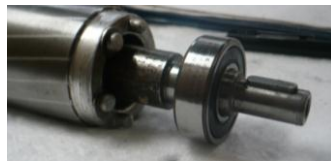
Gráfico 3.33: Montaje de la chaveta Fuente: Los Autores
