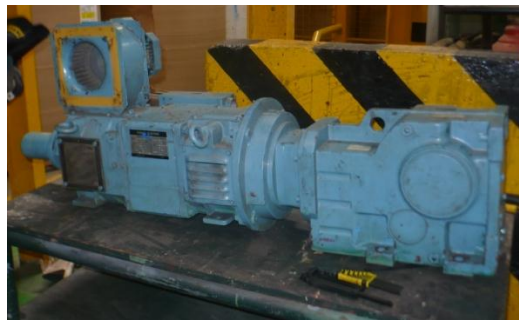
Gráfico 3.23: Desmontaje del motor reductor Fuente: Los Autores
