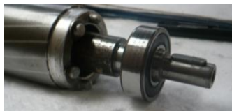
Gráfico 3.33: Montaje de la chaveta Fuente: Los Autores
