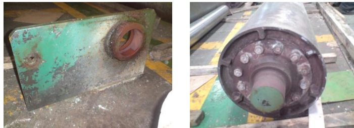
Gráfico 3.162: Desmontaje de la placa de soporte. Fuente: Los Autores
