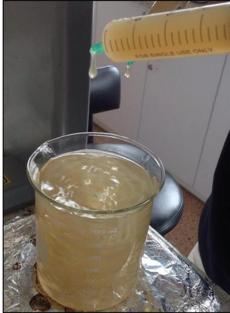
Figura 3. Goteo de las alginato de sodio en una solución de cloruro de calcio 1% (p/v) sometida a agitación.
