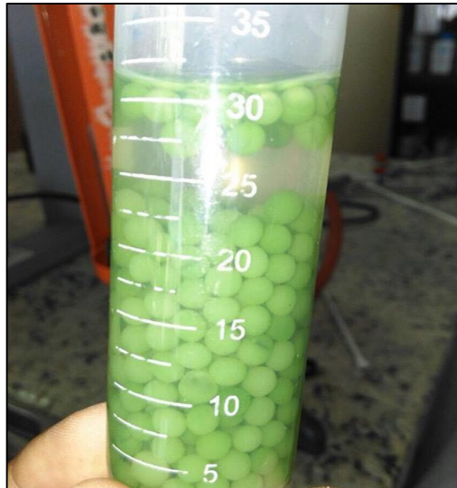
Figura 4. Microalga Chlorella sp. inmovilizada en perlas de alginato de calcio.
