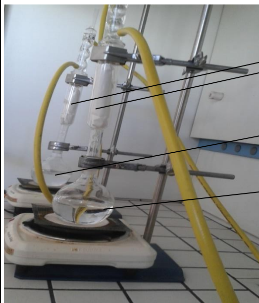
Figura 1. Proceso de extracción de extractos en la muestra de aserrín mediante etanol-benceno (V/V) Fotografía: Realizado por los autores (2016)
