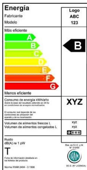
Figura 2.10 Etiquetado de eficiencia energética para aparatos de refrigeración de uso doméstico [63]
