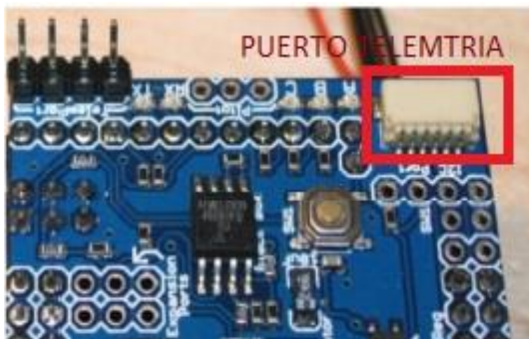
Figura 13 Puerto Telemetría del ArduPilot [2]
