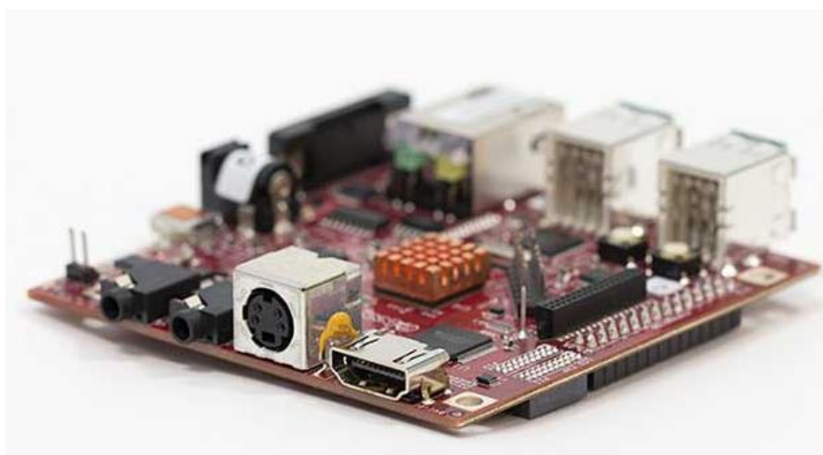
Figura 3 Plataforma embebida BEAGLEBOARD [8]
