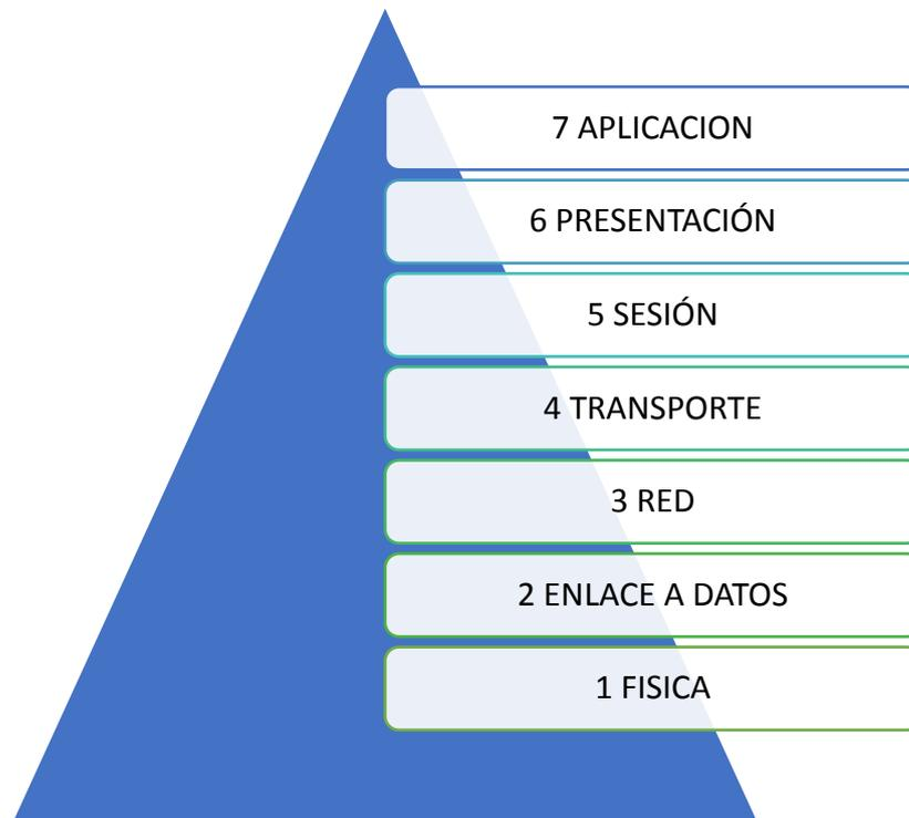
Figura 4: Capas del modelo OSI.
