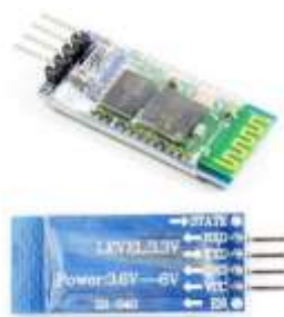
Figura 11: Módulo Bluetooth HC-06.
