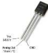
Figura 13: Pines de conexión del sensor de temperatura LM35
