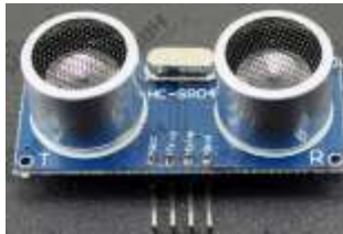
Figura 12: Sensor Ultrasónico HC-SR04.
