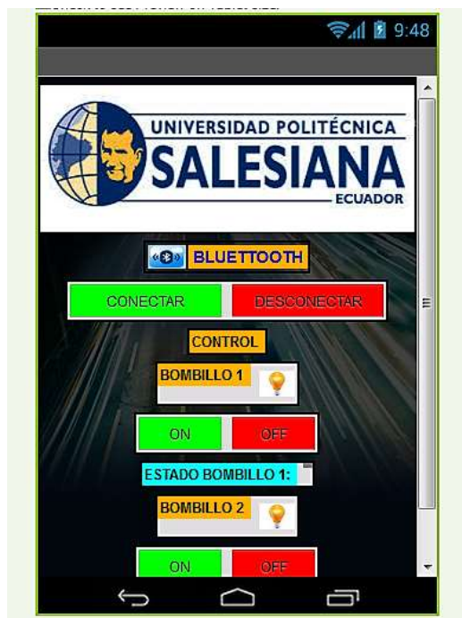
Aplicación final diseñada para el control ON/OFF de los bombillos.
