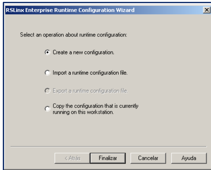
Figura 35. Crear una nueva configuración para enlace entre PLC y HMI en plataforma FactoryTalk View ME.
