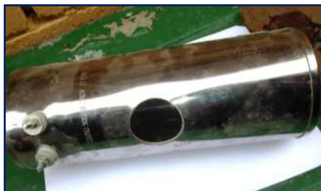
Figura 12 Resistencia de calentamiento, utilizado para homogenizar la temperatura en el barril de acero.
