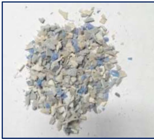
Figura 10 Material Polipropileno que utiliza la empresa Printecsa, para la elaboración de tacos Fisher.
