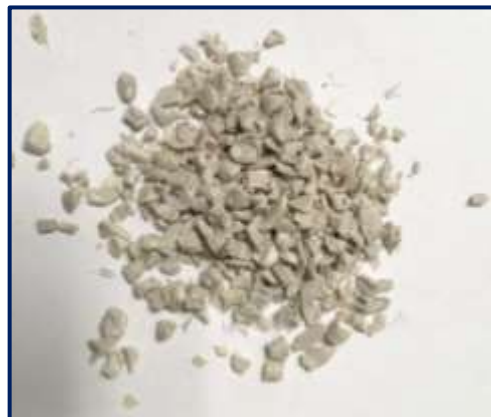
Figura 9 Material polietileno utilizado en la empresa Printecsa para la elaboración de grapas de cables.
