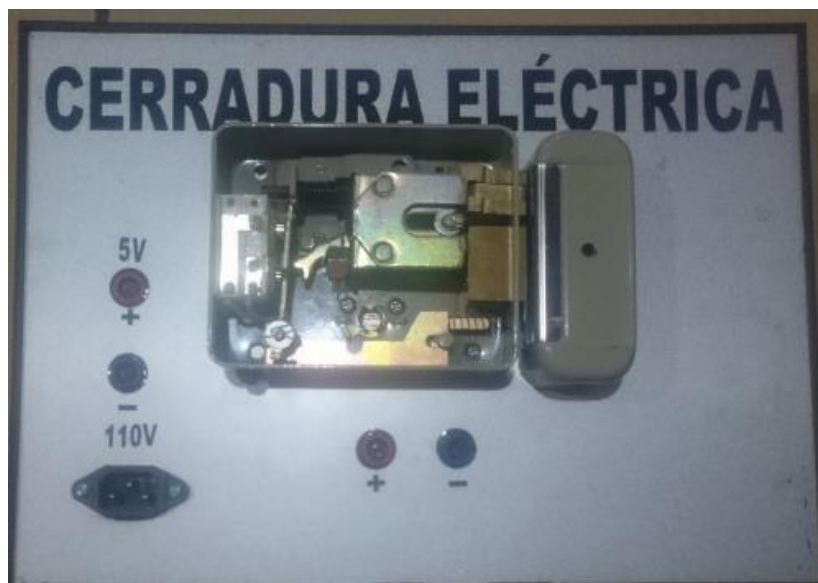
Figura 61. Lámina con Cerradura Eléctrica a 110V
