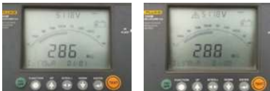
FIGURA 56: MEDICIÓN DE RESISTENCIA DE AISLAMIENTO DE CÁPSULA 1.
