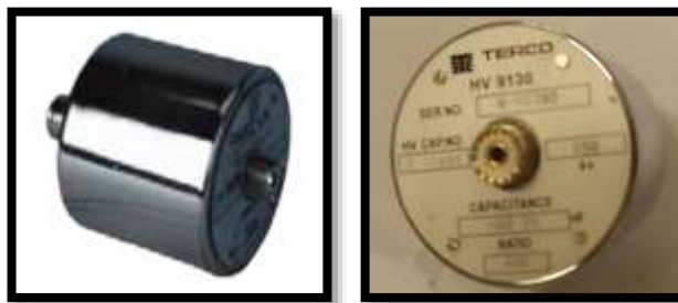
FIGURA 18: DIVISOR DE VOLTAJE O CAPACITOR DE ACOPLAMIENTO.
