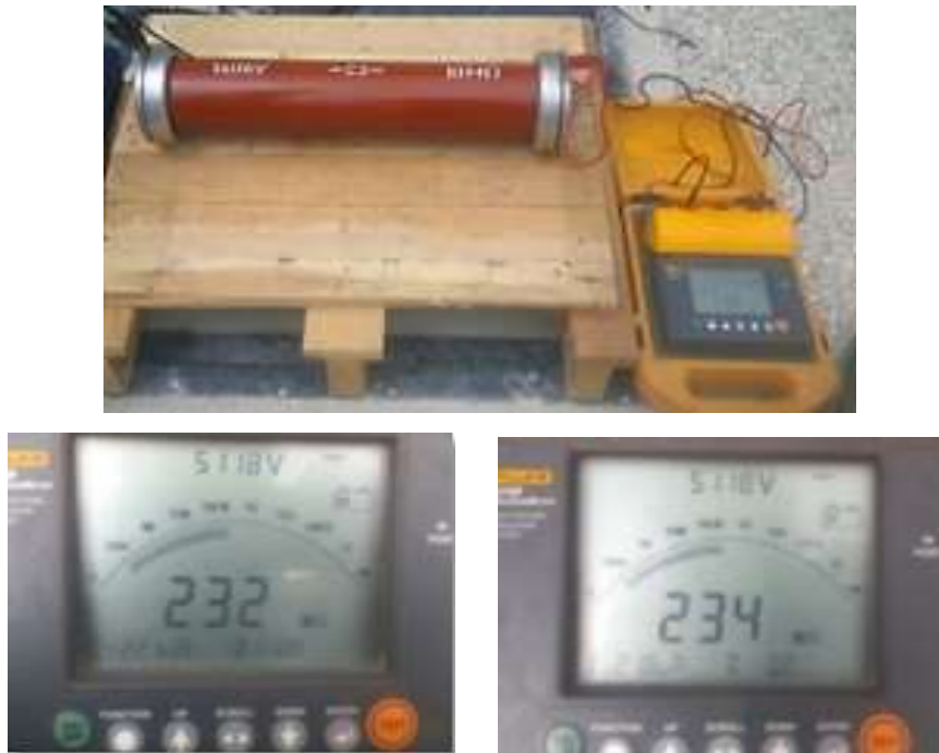
FIGURA 55: MEDICIÓN DE RESISTENCIA DE CÁPSULA DE LABORATORIO.
