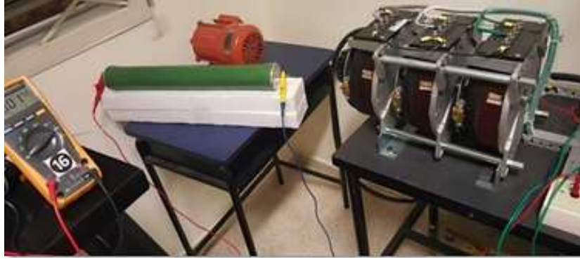
FIGURA 49: COMPROBACIÓN DE NIVELES DE RESISTENCIA DE 55 KΩ.
