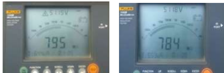
FIGURA 58: MEDICIÓN DE RESISTENCIA DE AISLAMIENTO DE CÁPSULA 2 DESPUÉS DE COLOCAR BARNIZ.
