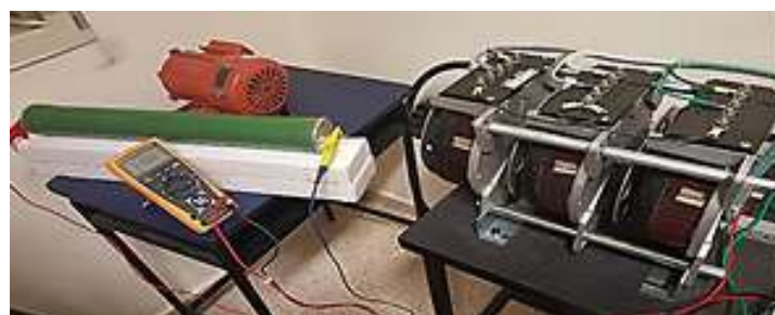
FIGURA 50: COMPROBACIÓN DE NIVELES DE RESISTENCIA DE 118 KΩ.
