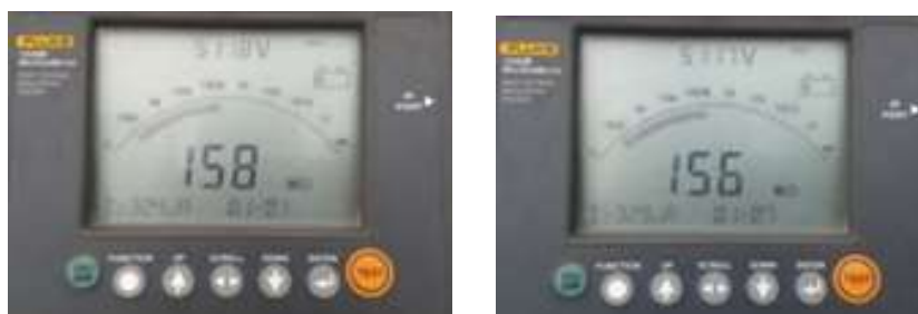
FIGURA 57: MEDICIÓN DE RESISTENCIA DE AISLAMIENTO DE CÁPSULA 2 ANTES DE COLOCAR BARNIZ.
