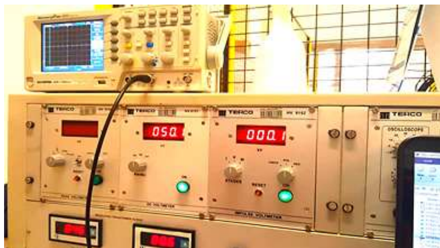
FIGURA 77: CONTROL VISUAL PARA PRUEBAS DE GENERACIÓN DE IMPULSO.
