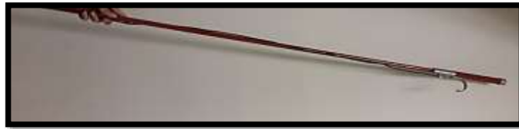
FIGURA 31: PÉRTIGA DE DESCARGA.
