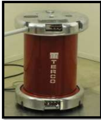
FIGURA 14: TRANSFORMADOR DE PRUEBA.
