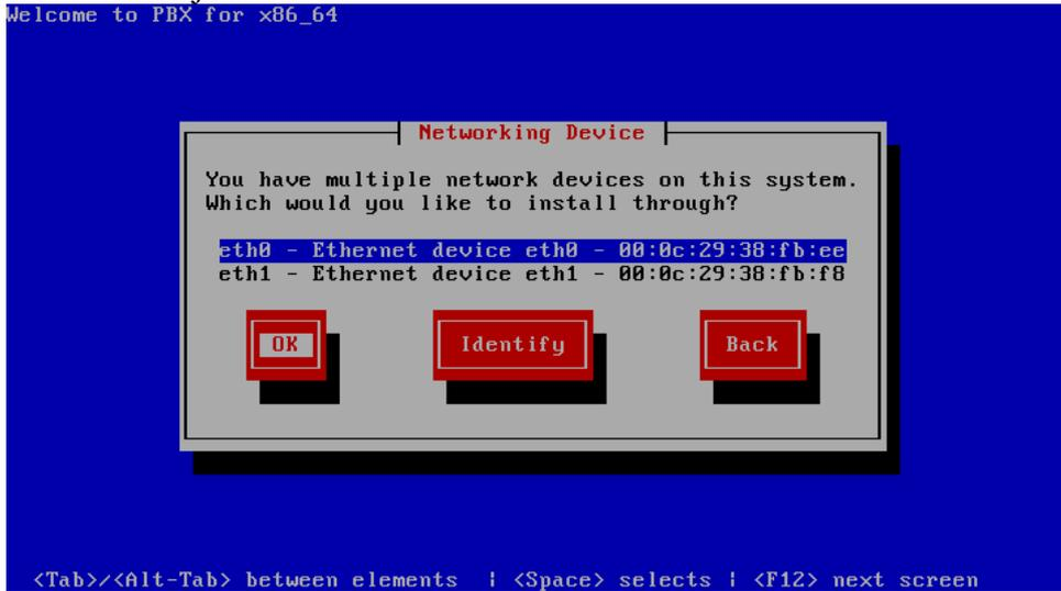
Figura 37. Selección de la tarjeta de red en la instalación
