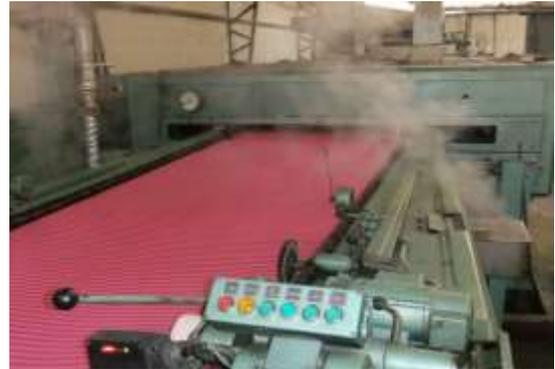
**Foto No. 4.8.- Rampa Termofijadora**
