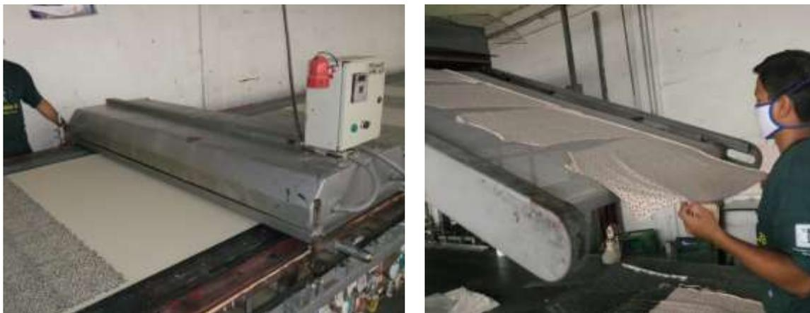
**Foto No. 4.17.- Cámara de secado**
