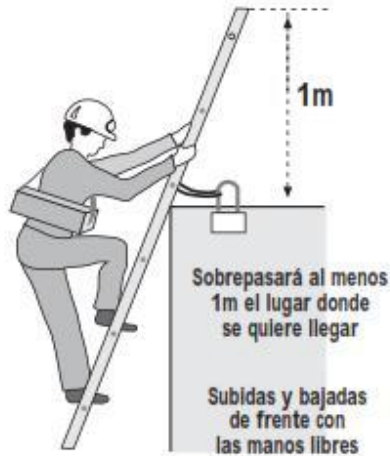
Imagen N°3: Sujeción y colocación de escalera de mano.
