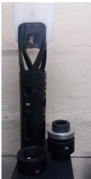
Figura 6: Mandril de etiquetado para tarrina de 250 gr. y 500 gr.
