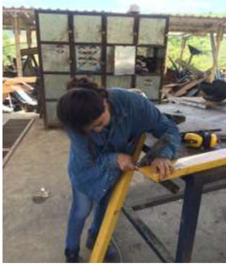
Paso 5. Unir las 4 partes del marco de la mesa y soldarlas.
