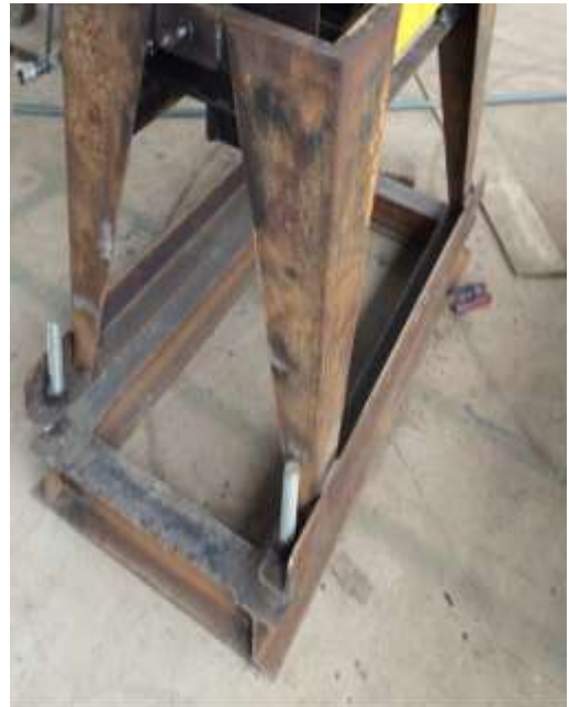
Paso 14. Construcción de base IPN para inclinación de la mesa.
