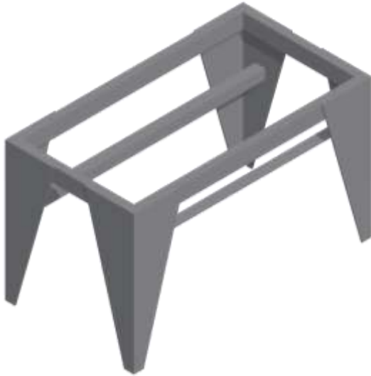
Figura 14 Estructura para soporte de mesa
