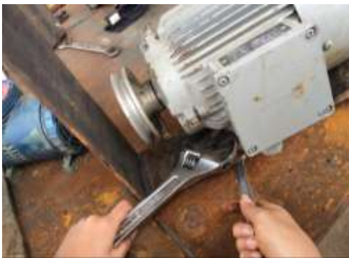
Paso 13. Instalación de chumaceras inferiores, contrapeso, motor y poleas.
