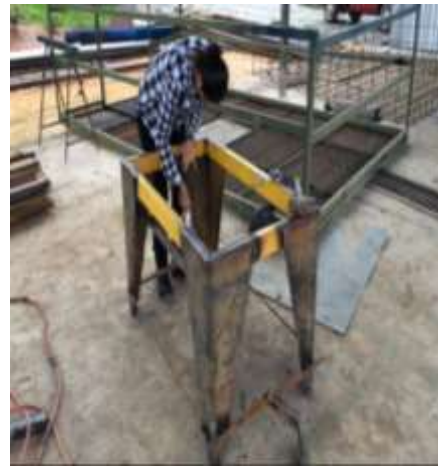
Paso 7. Medir, trazar, cortar y soldar soportes para la transmisión.
