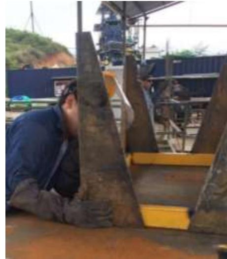
Paso 7. Medir, trazar, cortar y soldar soportes para la transmisión.
