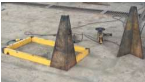
Paso 6. Soldar las patas dobladas a 90° con el marco de la mesa.
