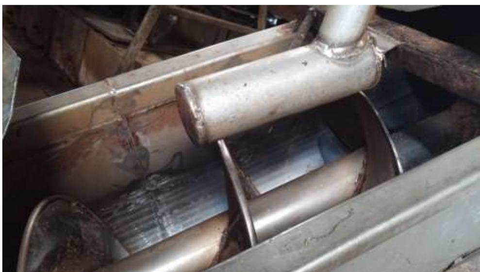
Se muestra la parte interna del molino húmedo y el dosificador de soluble de pescado
