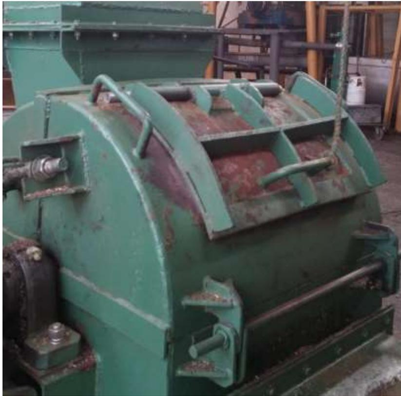
Se muestra la parte externa del molino de martillo.
