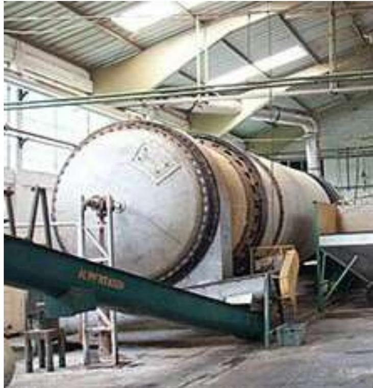
Se muestra el secador y los tornillos sin fin que transporta al molino de martillo.
