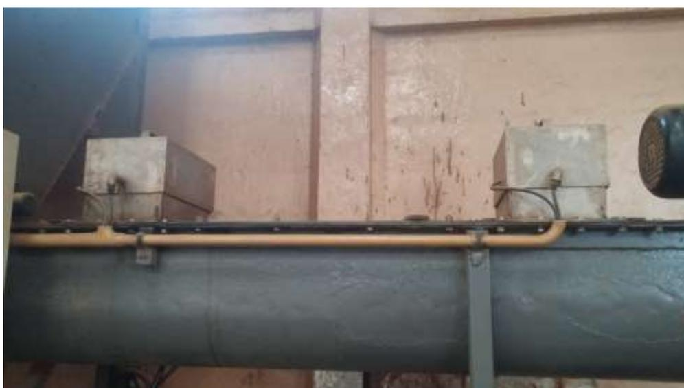
Se muestra tornillo sin fin junto con las cañerías que proveen los químicos y los rociadores automáticos
