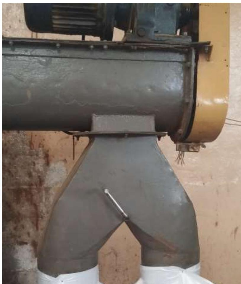
Se muestra máquina de ensacado.
