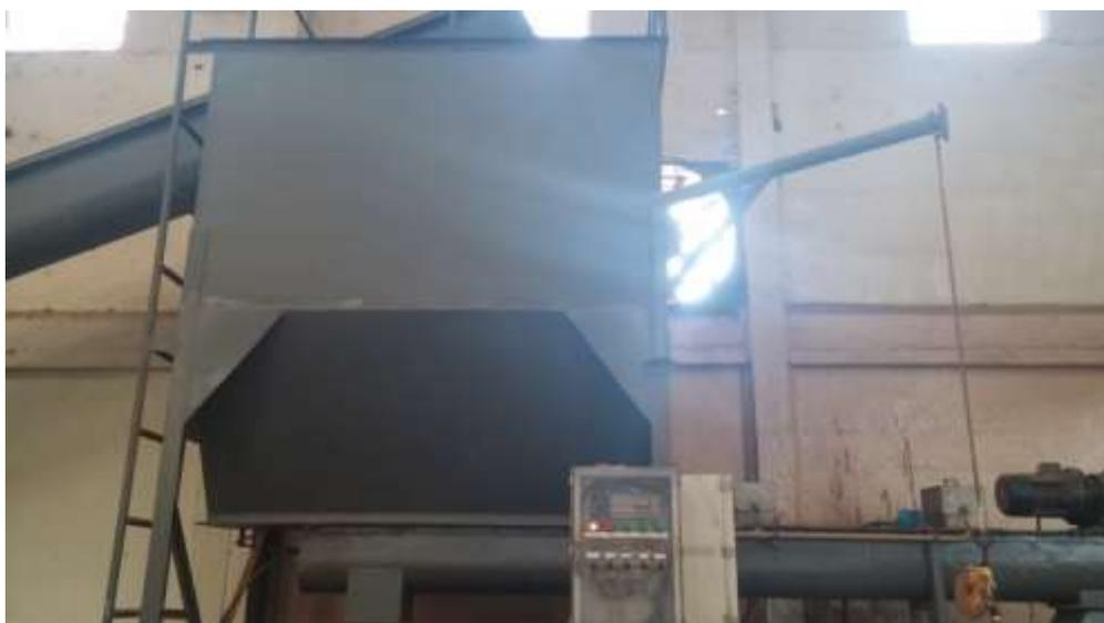
Se muestra silo de almacenamiento y tornillo sin fin del dosificador.
