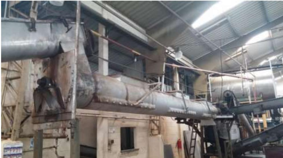
Se muestra la parte final del tornillo sin fin que alimenta el cocinador y la vista lateral del cocinador
