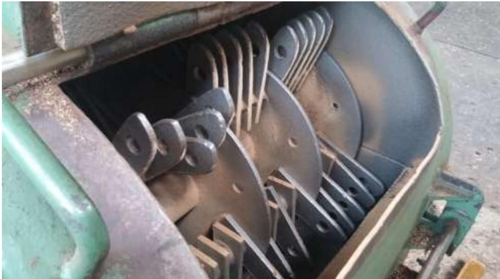
Se muestra la parte interna del molino de martillo.
