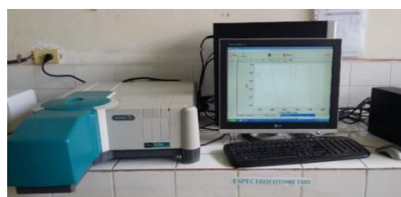
Figura 17. Prueba UV/VIS del pigmento SQ 2 . a) Diferentes disoluciones del pigmento SQ 2 en etanol a partir de 0,3 [mM] y b) Espectrofotómetro VARIAN 50 Bio UV-Visible. Elaborado por: Ruiz J. & Velasco J.
