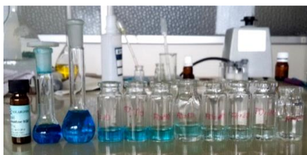
Figura 17. Prueba UV/VIS del pigmento SQ 2 . a) Diferentes disoluciones del pigmento SQ 2 en etanol a partir de 0,3 [mM] y b) Espectrofotómetro VARIAN 50 Bio UV-Visible. Elaborado por: Ruiz J. & Velasco J.
