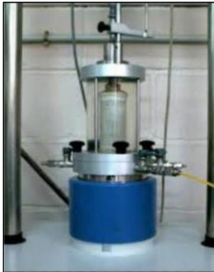
Figura 47. Máquina de cámara Triaxial.
