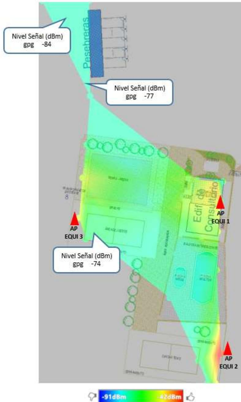
Figura 32 Intensidad de señal de los access point de equinoterapia
