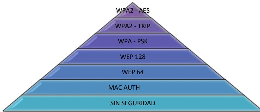
**Figura 4 Niveles de seguridad de red inalámbrica**
