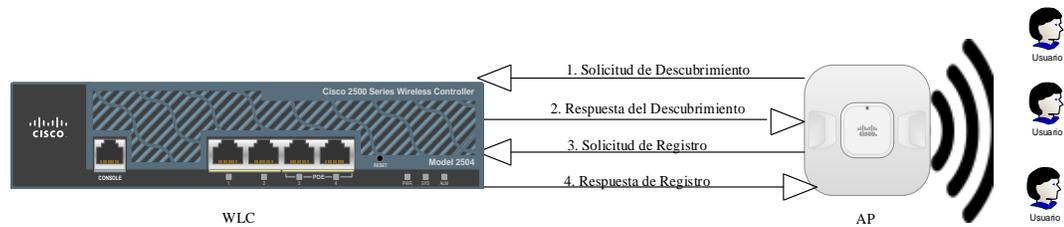
**Figura 21 Funcionamiento del WLC con el AP**
