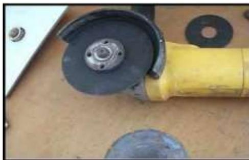
**Ilustración 136.** Amoladora con protector de disco aplicado **Fuente:** Autor
