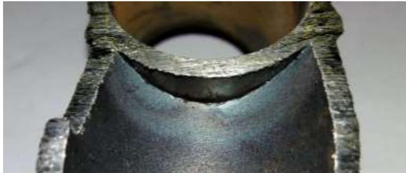
*Figure 45 Penetración de la soldadura probeta 1.*
