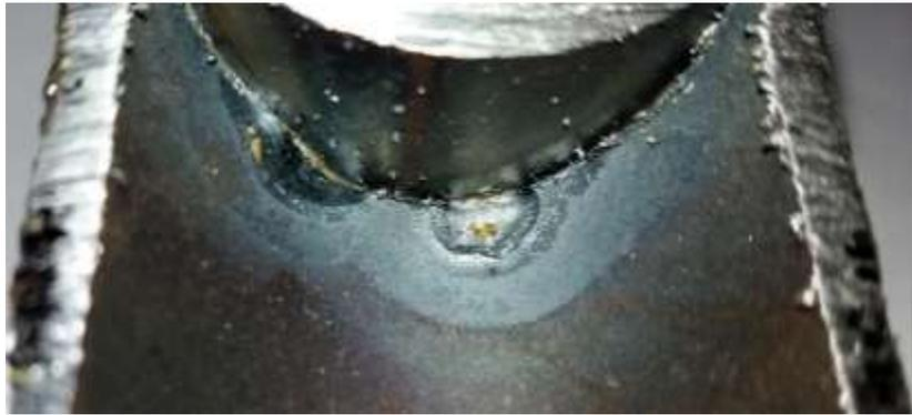
*Figure 47 Penetración de la soldadura probeta 3.*
