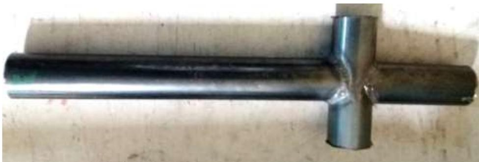
*Figura 27 Probeta en cruz.*
