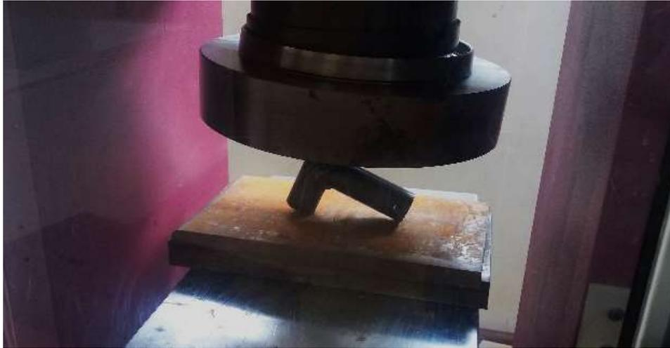
*Figure 39 Colocación de las probetas en la máquina de ensayo de compresión.*
