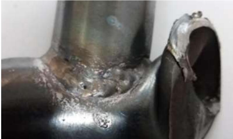
*Figure 44 Ensayo de compresión probeta 4.*
