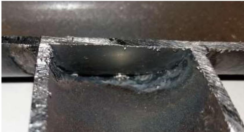
*Figure 48 Penetración de la soldadura probeta 4.*
