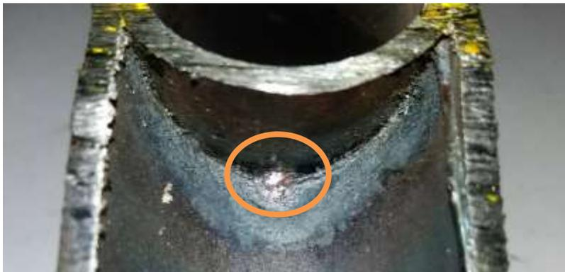
*Figure 46 Penetración de la soldadura probeta 2.*
