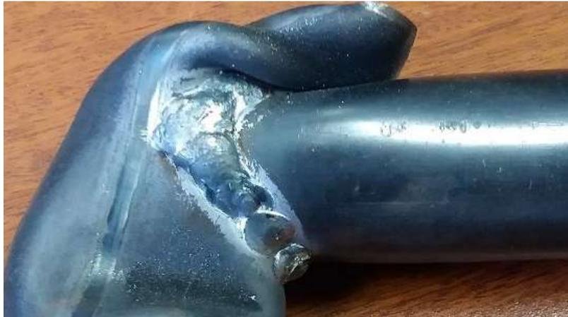
*Figure 42 Ensayo de compresión probeta 2.*
