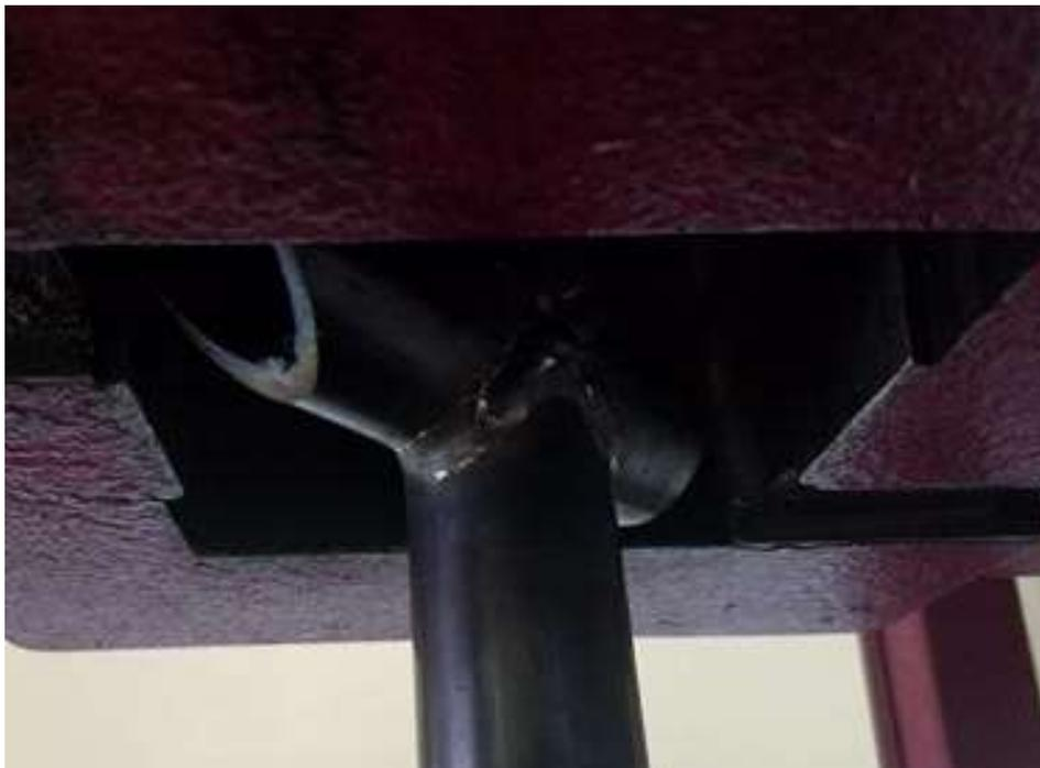
*Figura 28 Colocación de las probetas en la máquina de ensayo de tracción.*
