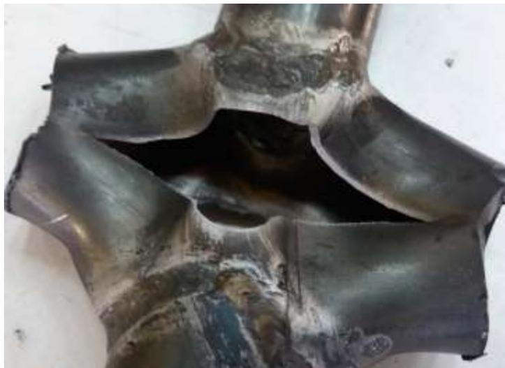
*Figure 37 Ensayo de tracción probeta 3.*
