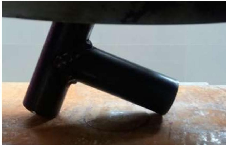
*Figure 40 Colocación de las probetas en la máquina de ensayo de compresión.*
