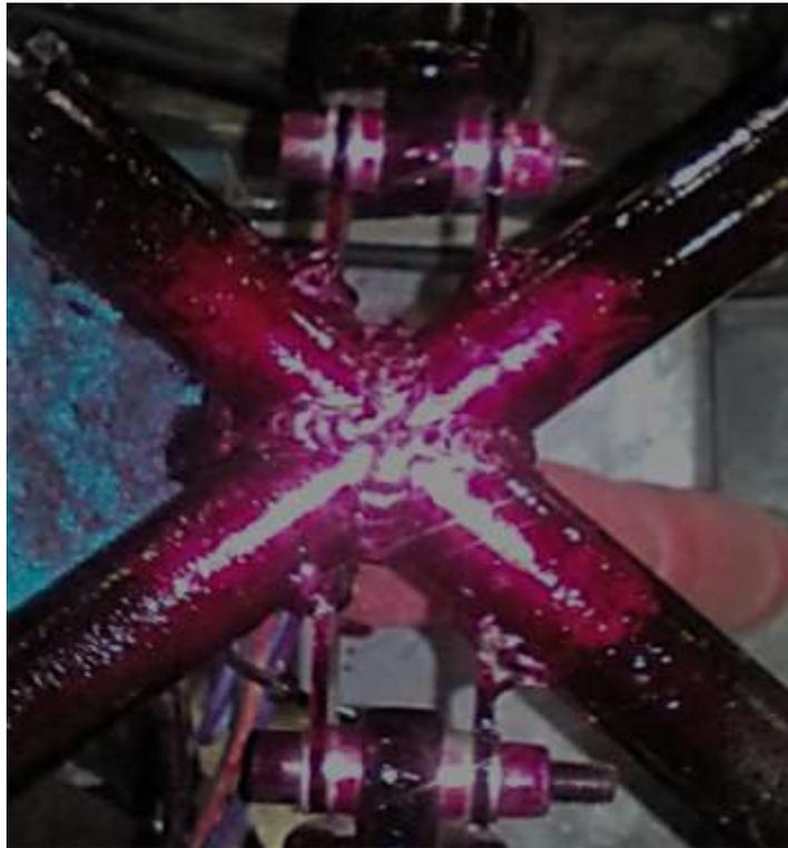
*Figura 9 Colocación del tinte penetrante*
