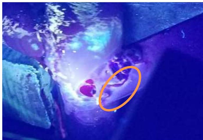
*Figura 13 Falta de fusión, visualizado con tintes penetrantes y luz ultravioleta.*
