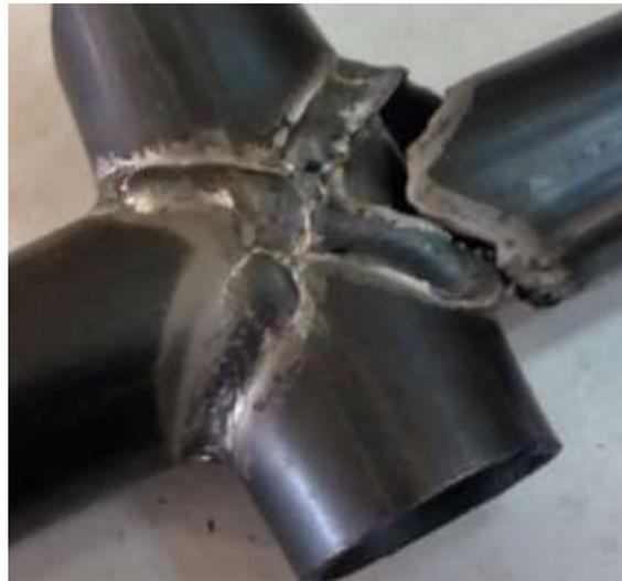
*Figure 30 Ensayo de tracción probeta 1*
