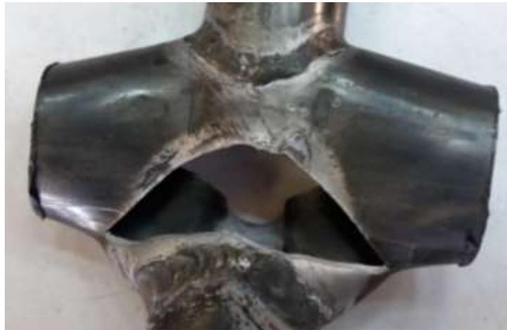
*Figure 36 Ensayo de tracción probeta 3.*
