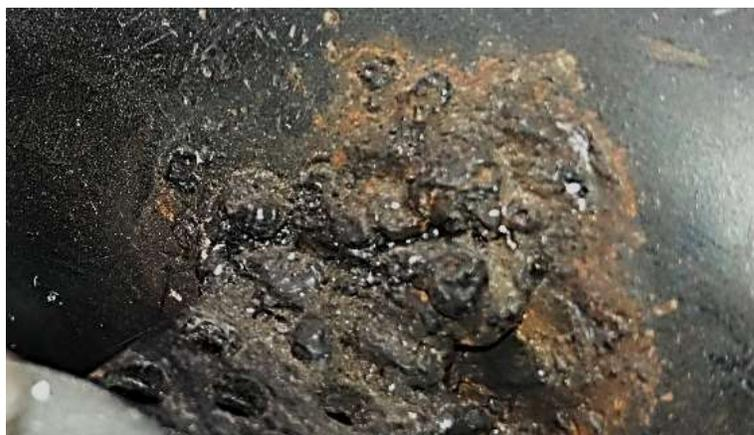
*Figura 23 Soldadura del escape.*
