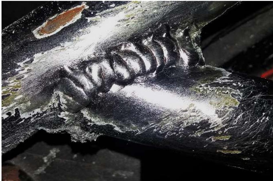
*Figura 10 Amontonamiento de la soldadura.*
