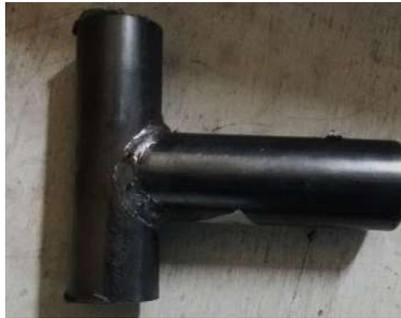
*Figura 26 Probeta en T.*
