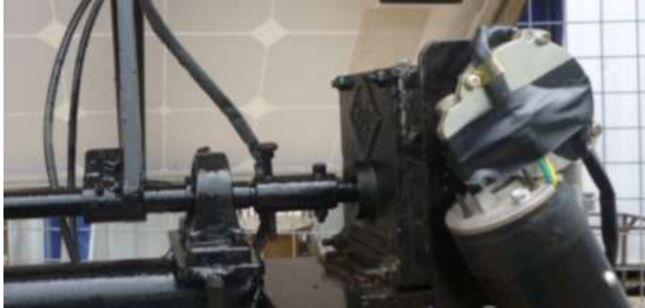
Figura 29. Acople base caja por medio de chumaceras y el eje del panel solar.
