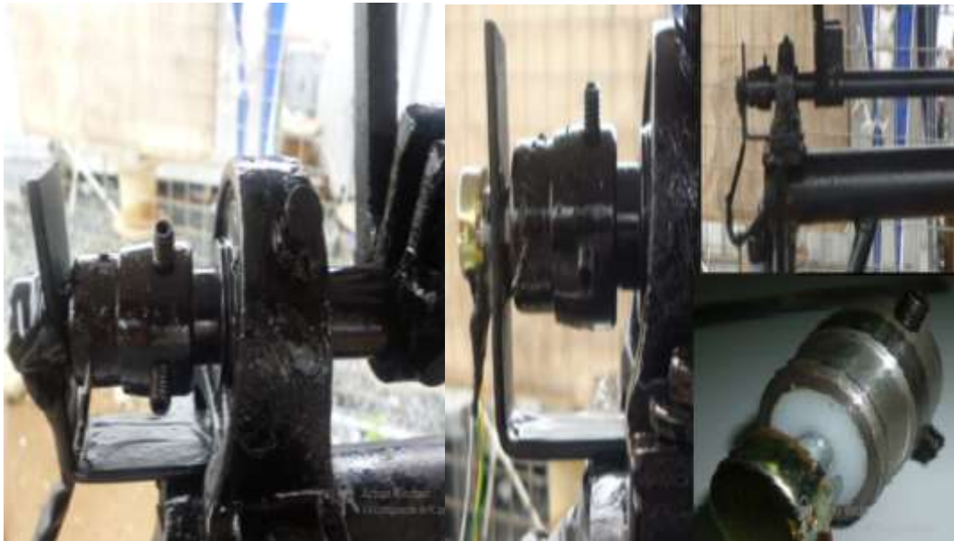
Figura 31. Acople potenciómetro con el eje del panel solar.
