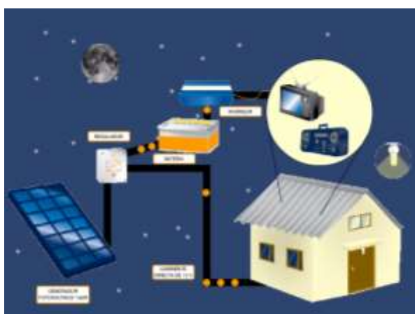
Figura 6. Energía solar fotovoltaica corriente alterna
