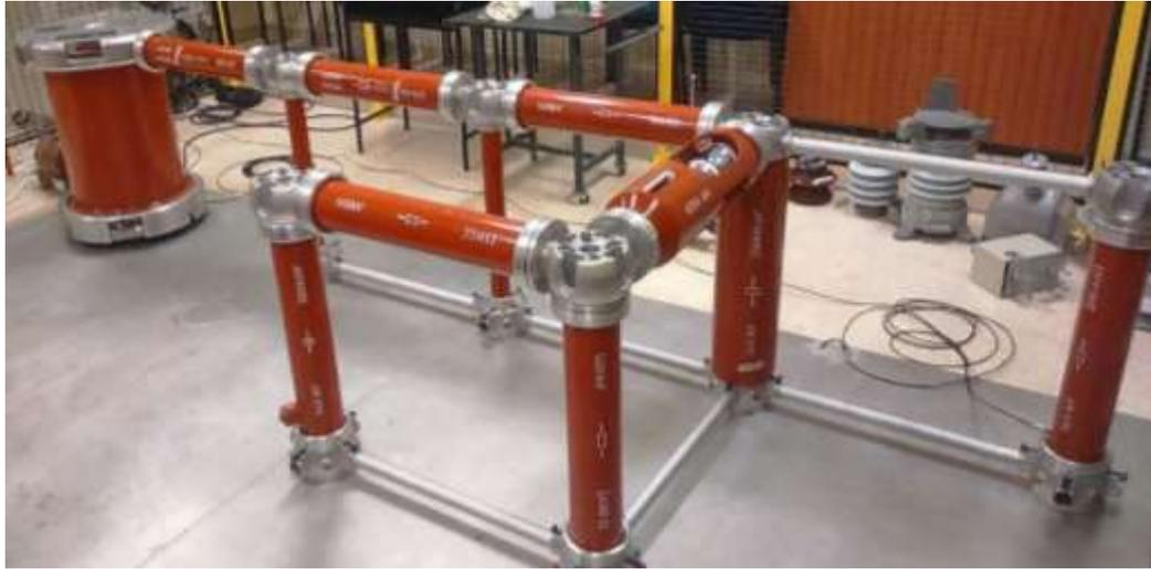
Ilustración 35. Circuito de Impulso implementado en el Laboratorio
