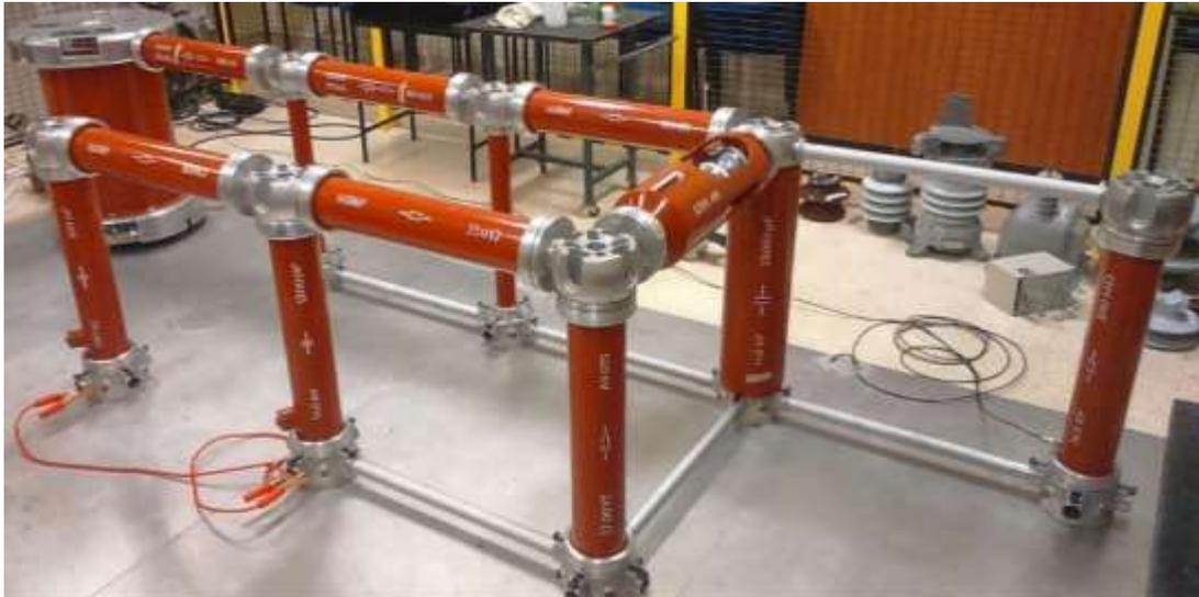
Ilustración 43. Circuito con derivación capacitiva montado en el laboratorio
