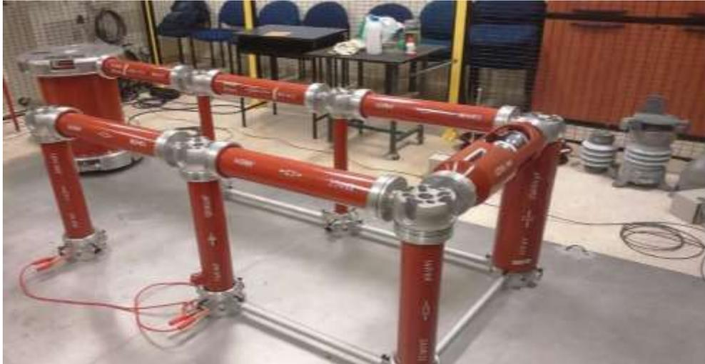
Ilustración 39. Circuito con derivación resistiva montado en el laboratorio
