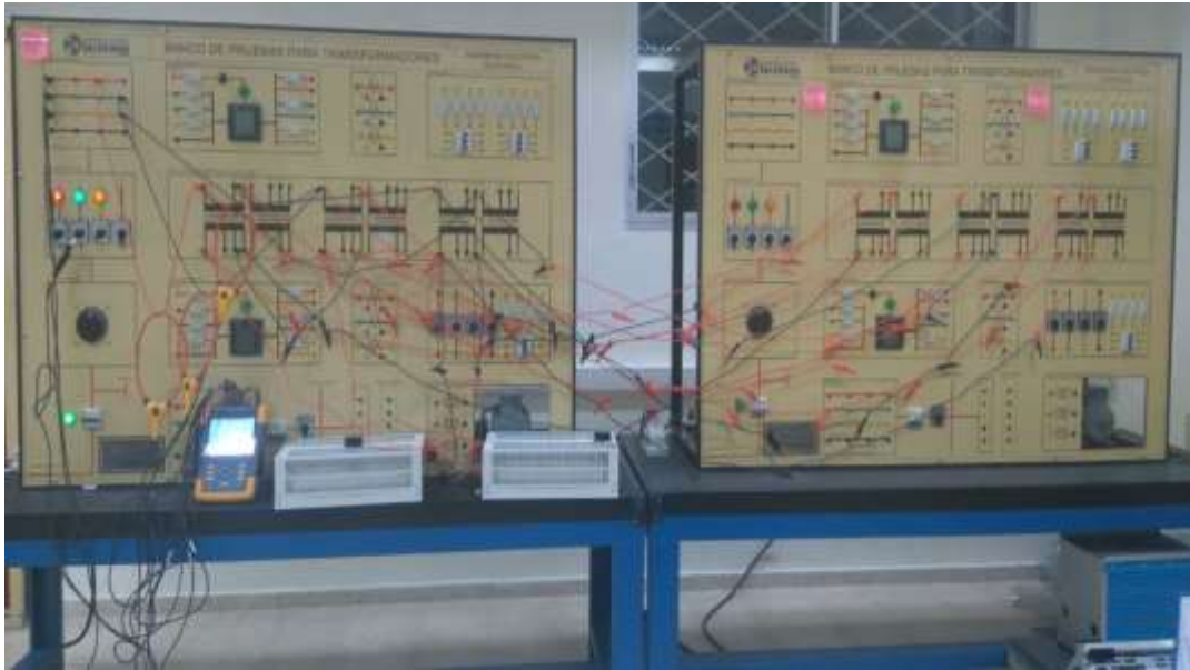
Ilustración 37. Acople de dos bancos trifásicos dYN11 con carga, en bancos de pruebas de transformadores.
