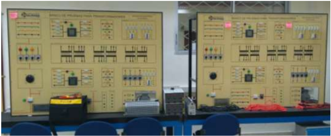
Ilustración 35. Bancos de pruebas para transformadores.
