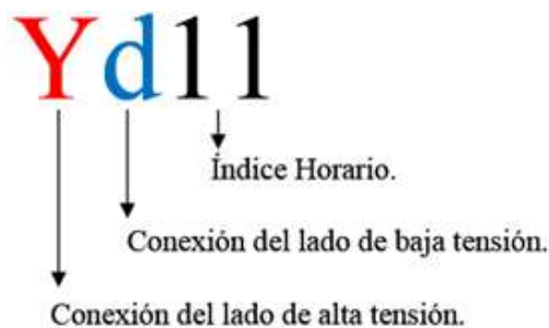
Ilustración 9. Nomenclatura grupo de conexión transformadores trifásicos.
