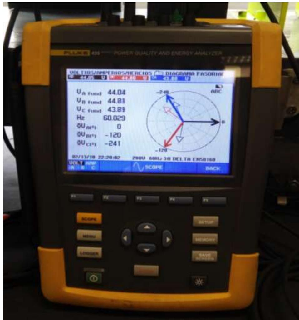
Figura 58. Diagrama Fasorial Voltaje Línea – Línea secuencia (+) R-S-T
