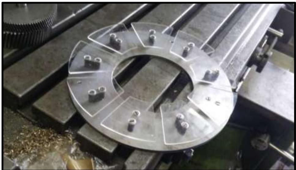
*Figura 34.* Armadura del estator
