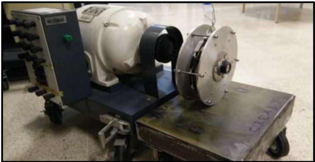
*Figura 54. Acople de la máquina primaria con el generador tipo axial*
