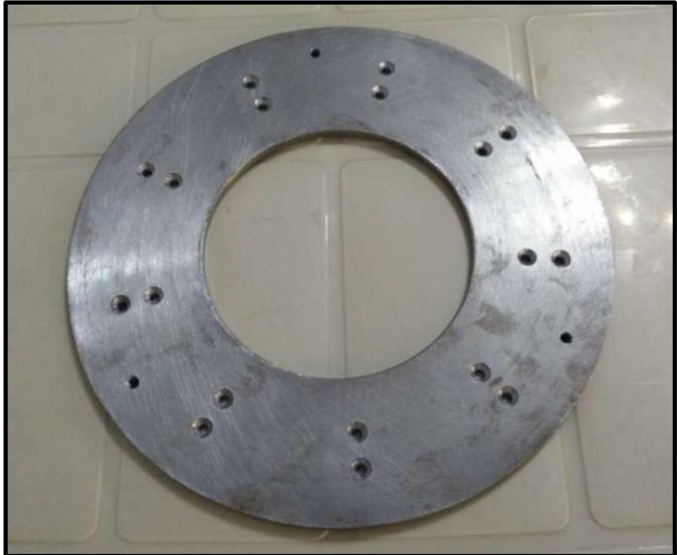
*Figura 33.* Placa principal de la armadura del estator
