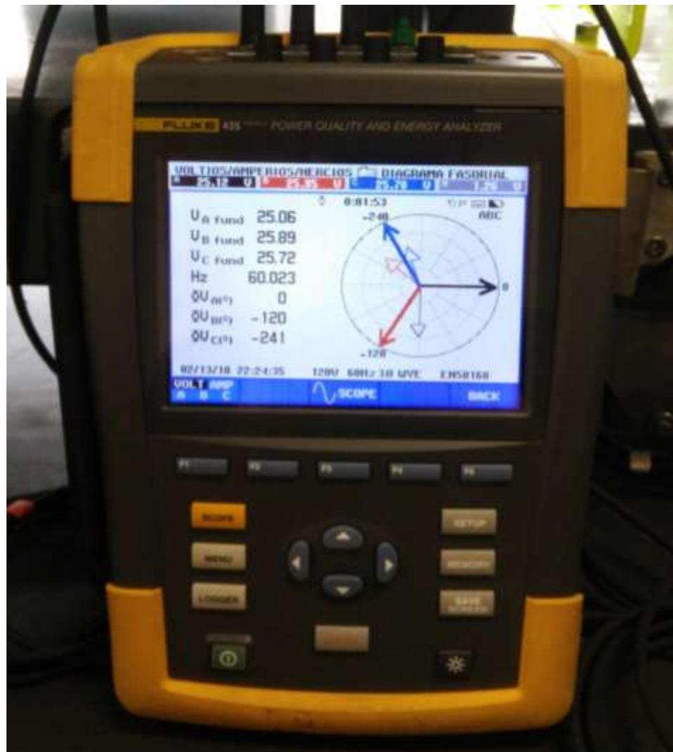
Figura 61. Diagrama Fasorial Voltaje Línea – Neutro secuencia (+) R-S-T
