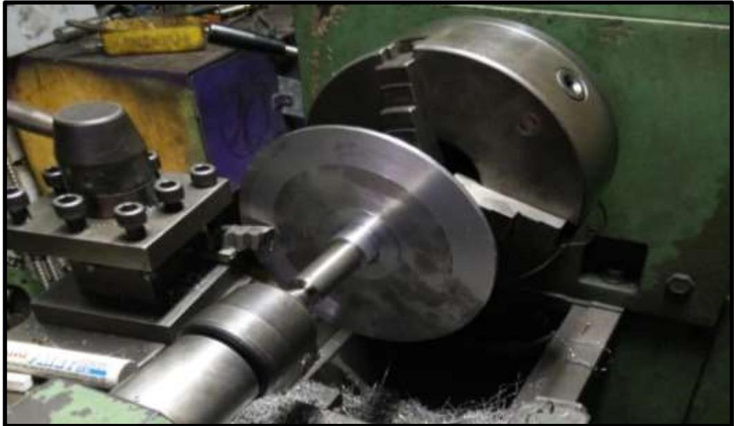
*Figura 42.* Fabricación del rotor inductor del generador
