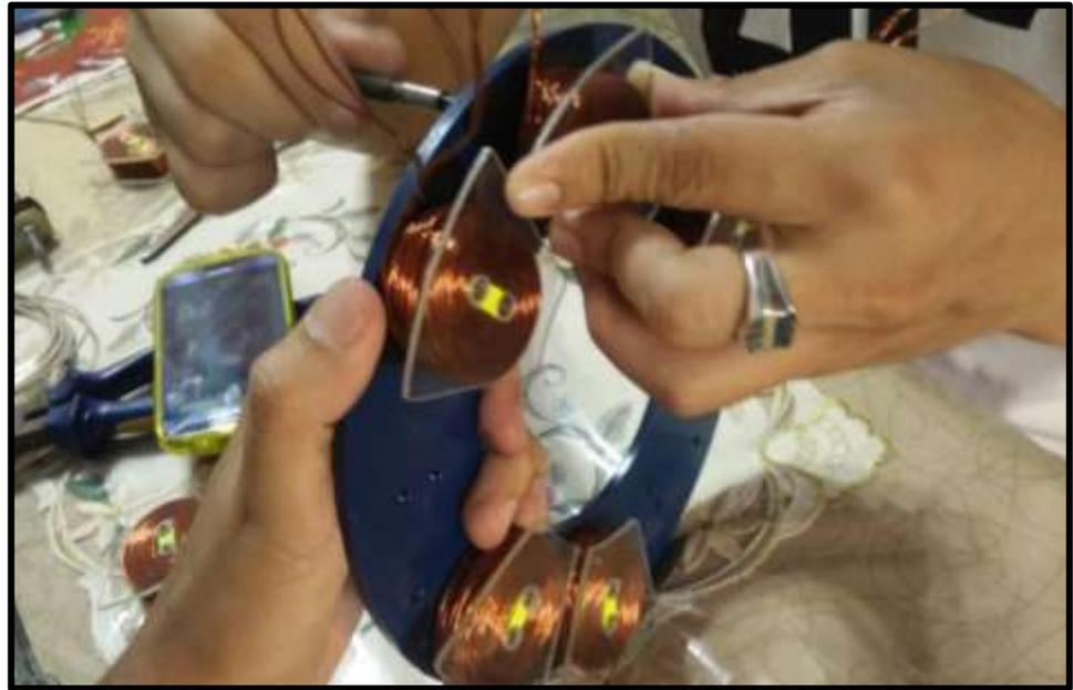
*Figura 37.* Ensamble de las bobinas en la armadura del estator
