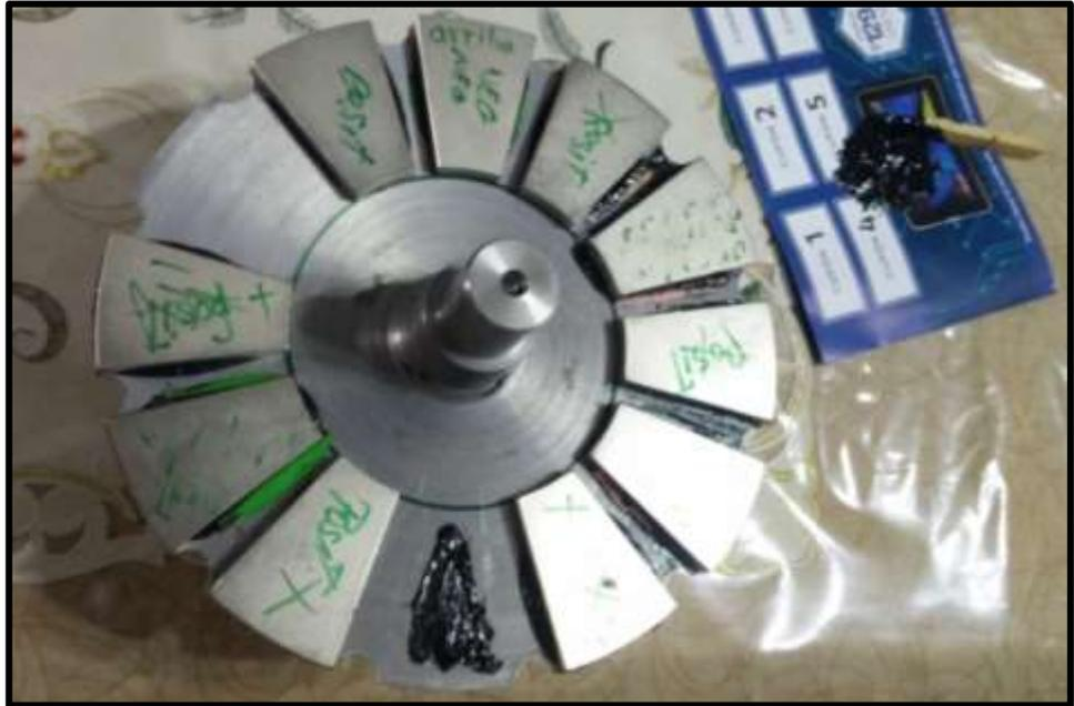
*Figura 43.* Montaje del collar de imanes en el disco inductor
