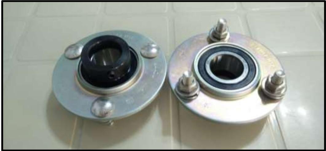
Figura 49. Rodamientos con sus soportes de brida
