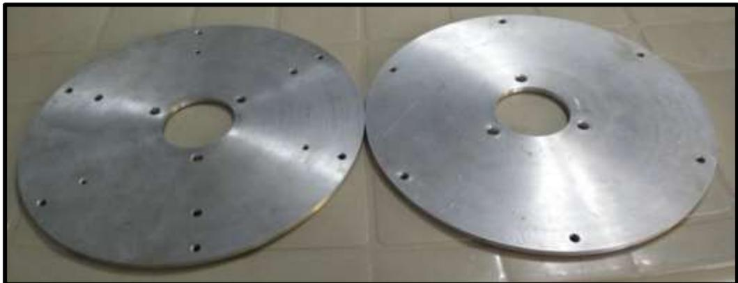
*Figura 47.* Discos de la carcasa del generador
