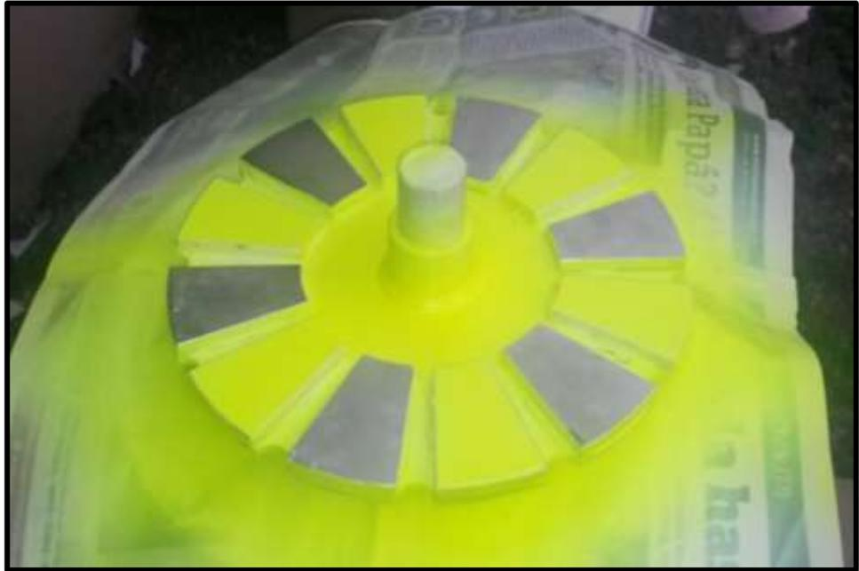
*Figura 45. Pintado final del rotor inductor*
