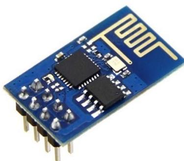
**Figura 19:** Módulo Wi-Fi ESP8266 [32].
