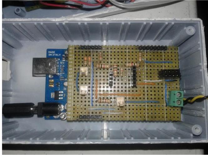
**Figura 23:** Placa para el acople de los módulos con el Arduino
