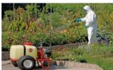
Figura 5. Vista general del equipo tipo lanza.
