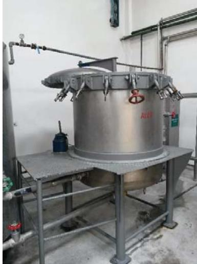
Figura 5. Tanque para filtrado con carbón activo
