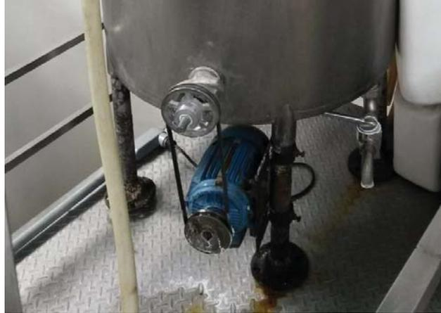
Figura 13. Motor para agitador de sabores
