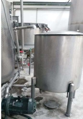
Figura 4. Tanque de precapa con tierra filtrante
