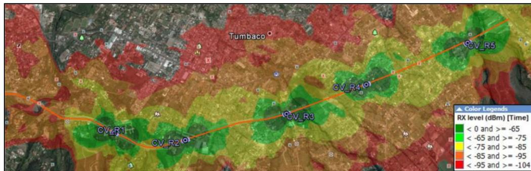
Figura 99. Simulación cobertura 2G para Claro en la Ruta Viva
