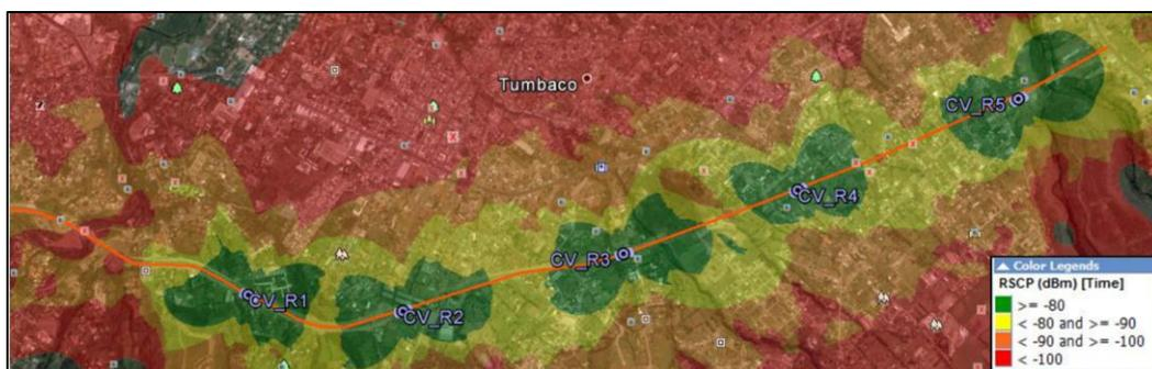
Figura 100. Simulación cobertura 3G para Claro en la Ruta Viva
