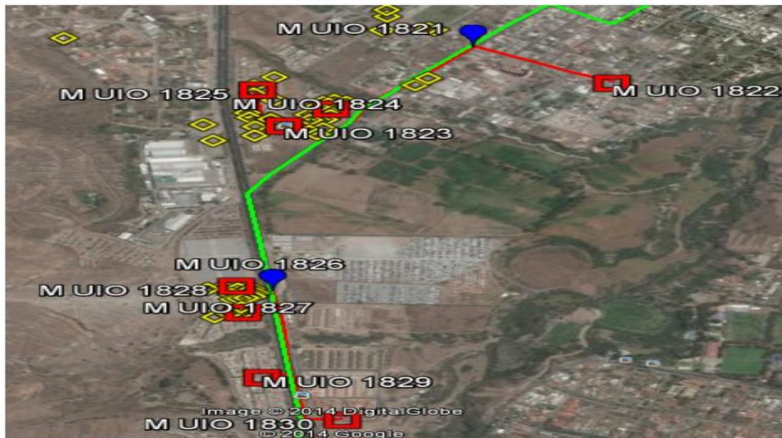
Figura 15. Georreferenciación de Mangas y Abonados – Fase 4. Fuente: NOC-PUNTONET S.A. Elaborado por: Paulina Argüello.
