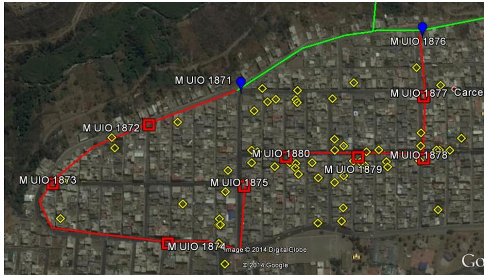
Figura 20. Georreferenciación de Mangas y Abonados – Fase 9. Fuente: NOC-PUNTONET S.A. Elaborado por: Paulina Argüello.
