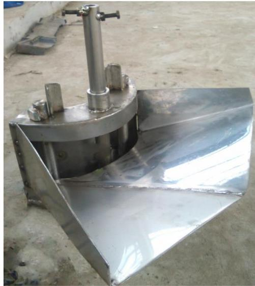
Figura 13. Estructura realizada en inox para el molde transversal.
