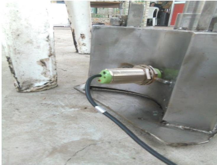
Posición del sensor en el molde transversal
