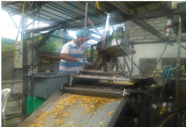
Figura 26. Montaje del abastecimiento sobre la freidora industrial que se encuentra en la empresa " El Campeón".
