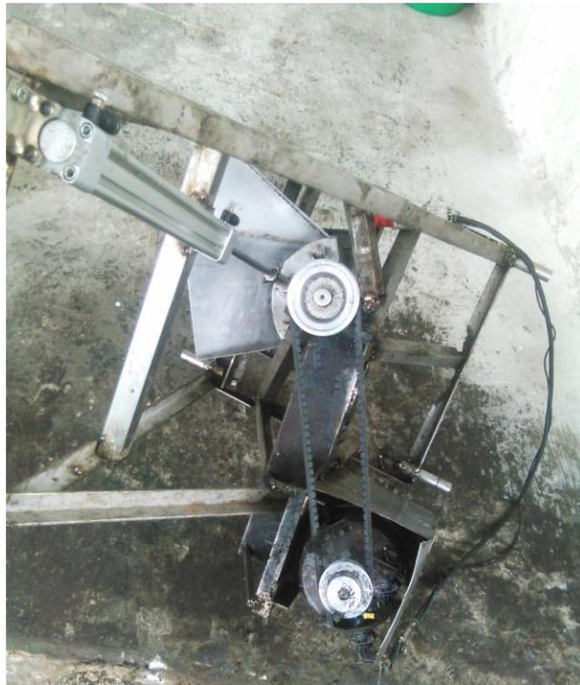
Figura 25. El montaje se lo realizó con estructuras en acero inoxidable.
