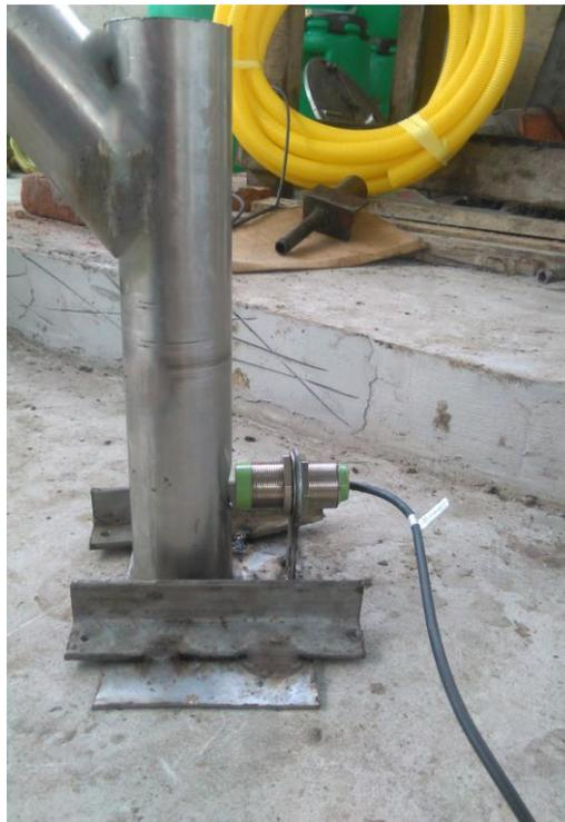
Posición del sensor en el molde longitudinal
