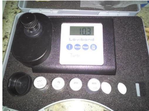
Figura 4. Turbidímetro Lovibond, Valor de turbidez estimado de la caracterización del ARD.
