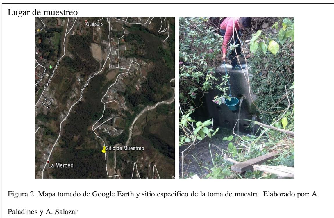
Las muestras se las tomaron directamente del dique, mediante un balde de 10 litros. Posteriormente, se procedió a almacenar la muestra en una caneca de 20 L para su transporte hasta las instalaciones de la Universidad, la cual se encuentra a una hora aproximadamente desde el sitio de muestreo. Una vez dentro de los laboratorios de la Facultad se conservó el ejemplar a una temperatura de 3-4°C.
