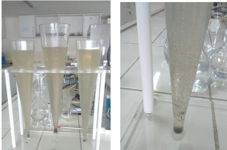
Figura 3. Muestra de ARD en Conos Imhoff después de 24 horas Elaborado por: A. Paladines y A.
