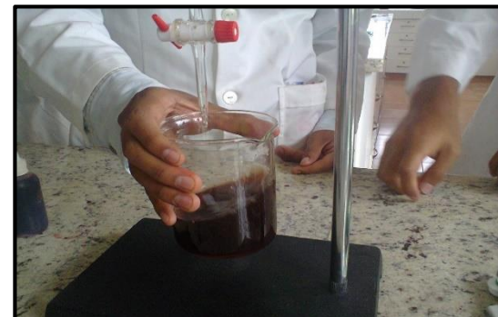
23.2. Punto de viraje de la reacción de titulación de suelo
