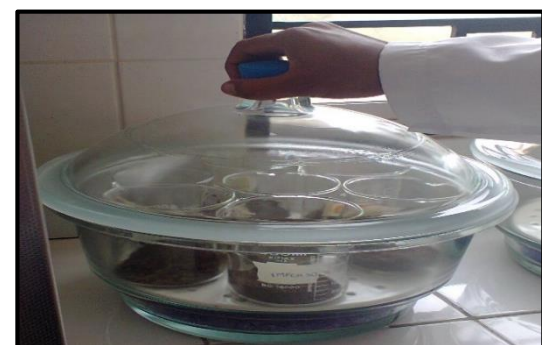
19.2. Estabilización de muestras en el desecador
