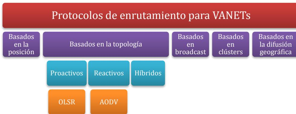
Figura 5. Clasificación de los protocolos de enrutamiento para VANETs.
