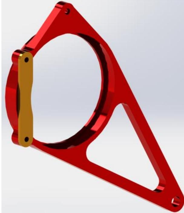
*Figura 5.24. Vistas de elemento de sujeción del diferencial lado izquierdo con placa limitadora posicionada [9].*
