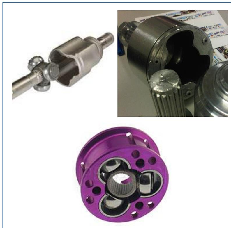
*Figura 4.6. Diferencias entre juntas comercial, de diseño comercial fabricada en aluminio y de doble cuerpo aluminio-acero [9].*
