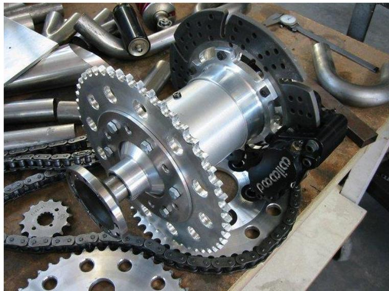
*Figura 4.10. Diferencial con rueda dentada para alojar la cadena de transmisión y con freno de disco en la carcasa [13].*
