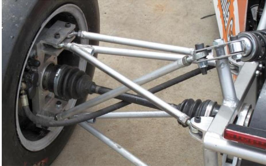
*Figura 4.4. Mangueta y componentes de suspensión posterior de vehículo FSAE alemán. [7].*
